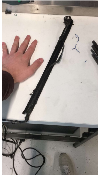
Figura 35 - Material obtido utilizando o processo de consolidação in-situ
