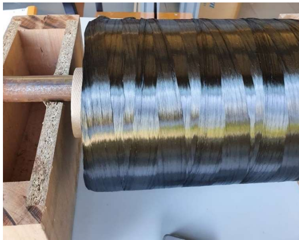
Figura 16 - Bobina utilizada para a alimentação de fibra
