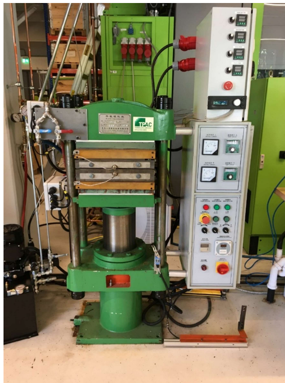
Figura 38 - Prensa utilizada no processo de extrusão
