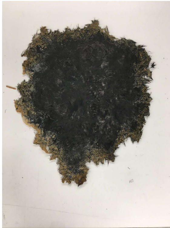
Figura 39 - Resultado da consolidação do material obtido na extrusora por compressão a quente
