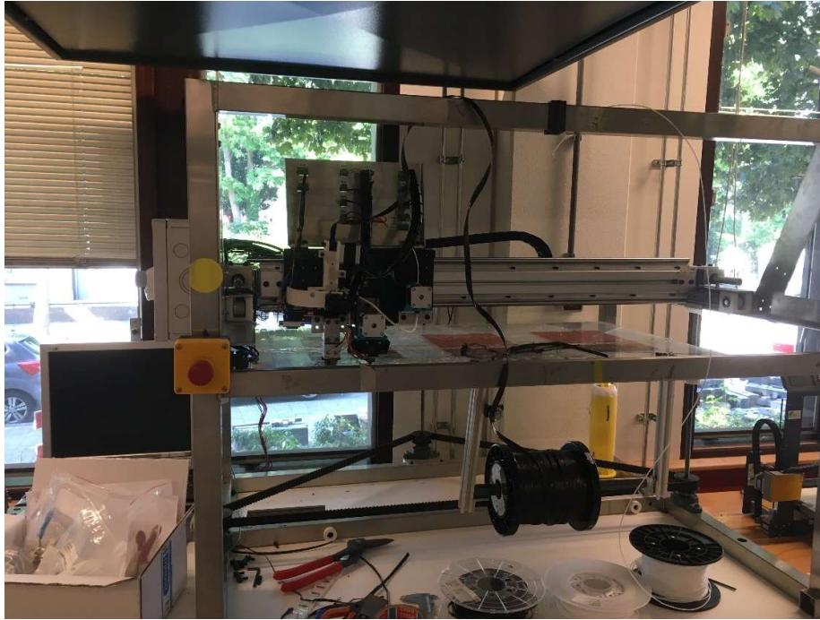
Figura 34 - Máquina de consolidação in-situ utilizada
