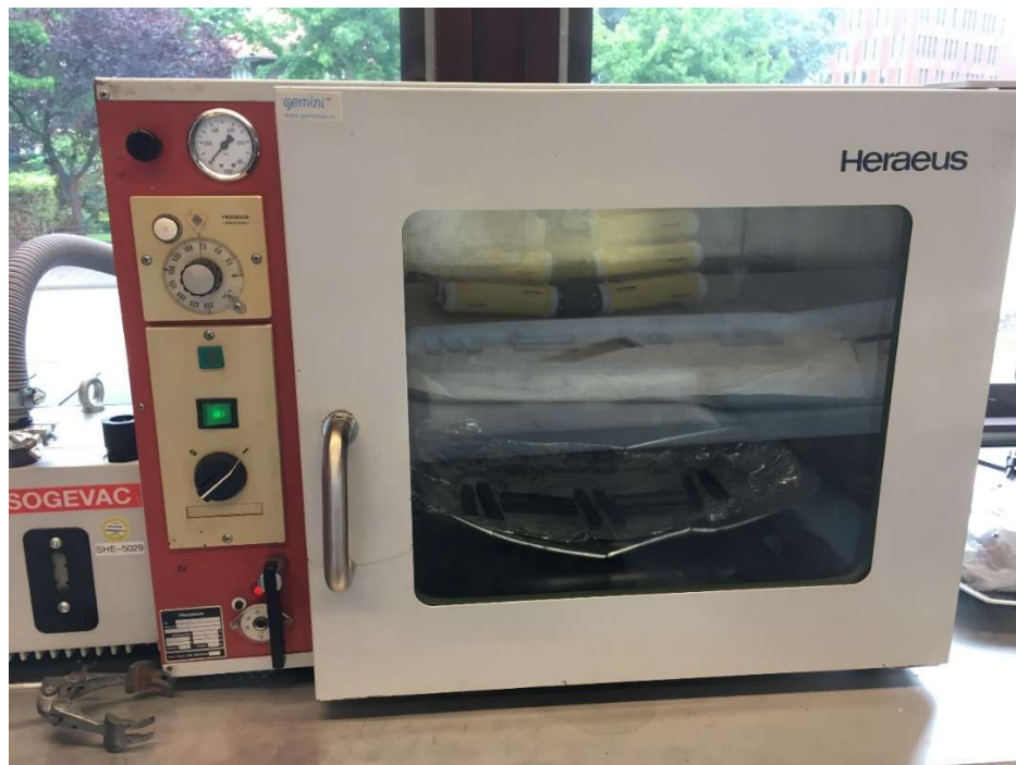
Figura 28 - Forno com vácuo Heraeus VT 5042 EK
