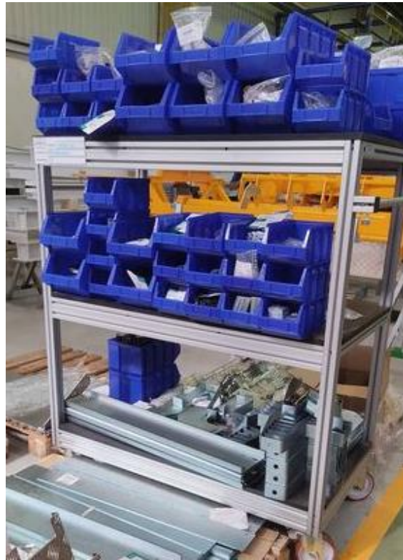
Figura 32 - Abastecimento de material às estações de trabalho: Estado inicial
