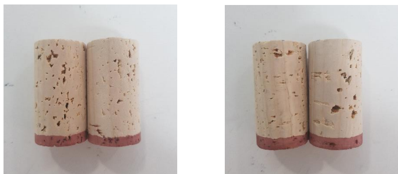
Figura 2.45 Capilaridade de rolhas Naturais após aplicação do primeiro componente e após o segundo componente relativas ao ensaio 4.
