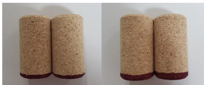
Figura 2.60 Capilaridade de rolhas Neutrocork após aplicação do primeiro componente e após o segundo componente relativas ao ensaio 3.
