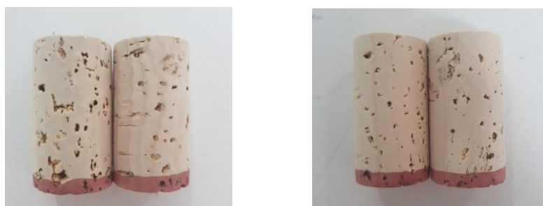
Figura 2.46 Capilaridade de rolhas naturais após aplicação do primeiro componente e após o segundo componente relativas ao ensaio 5.
