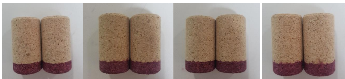
Figura 2.59 Capilaridade de rolhas neutrocork após aplicação do primeiro componente e após o segundo componente relativas ao ensaio 1 e 2, respetivamente
