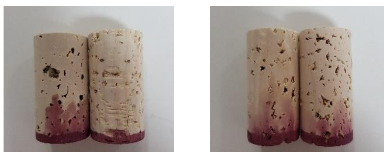
Figura 2.44 Capilaridade de rolhas naturais após aplicação do primeiro componente e após o segundo componente relativas ao ensaio 3.
