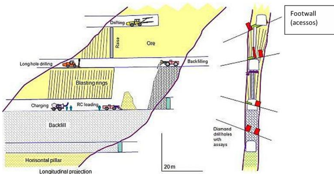
Figura 8 - Método de exploração 'Bench and Fill' e posterior enchimento (adaptado de Ferreira, 2015).
