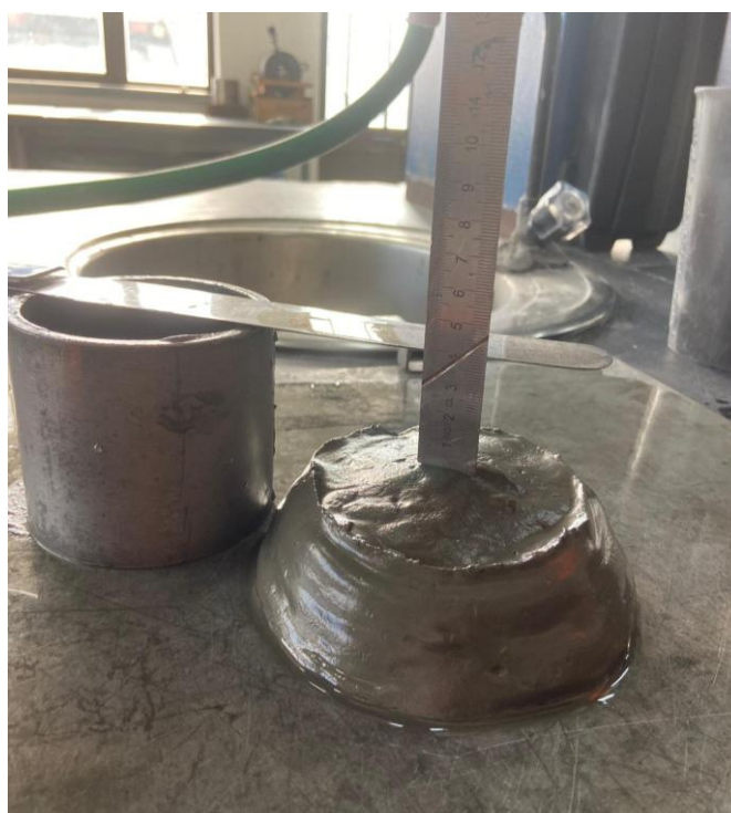
Figura 25 – Exemplo de ensaio de abaixamento ( slump ).
