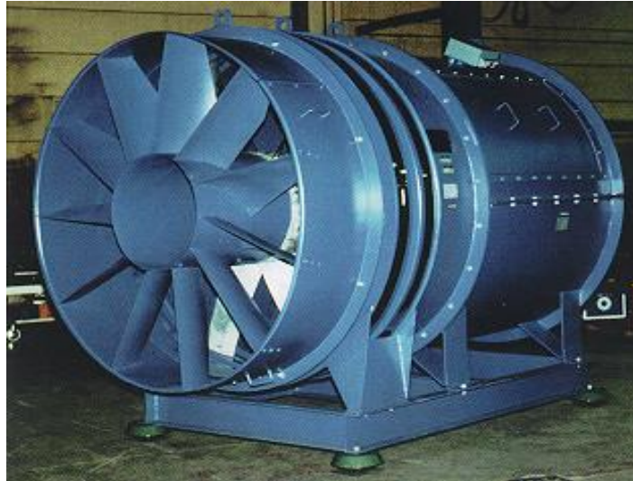
Figura 3. 1- Exemplo de um ventilador do tipo axial [18]
