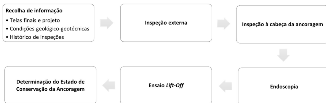
Figura 10 - Fluxo de trabalhos para determinação do EC de ancoragens, segundo a metodologia de Taiwan (adaptado de Hn-S et al., 2013).
