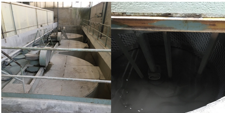
Figura 2.10. Três tanques de armazenagem da barbotina (lado esquerdo) e interior do tanque (lado direito).
