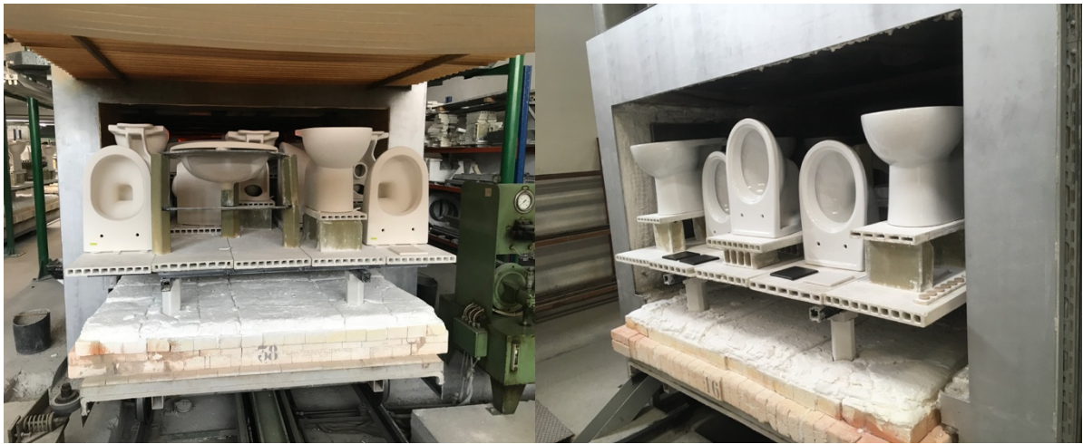
Figura 2.16. Peças à entrada (lado esquerdo) e saída (lado direito) do forno.
