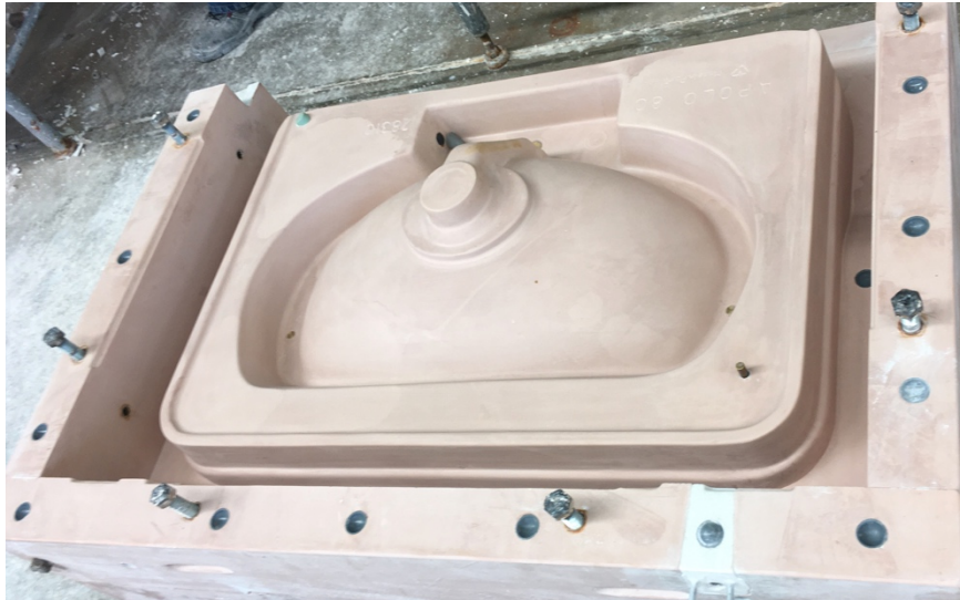
Figura 2.7. Construção de uma matriz em gesso correspondente a um lavatório.
