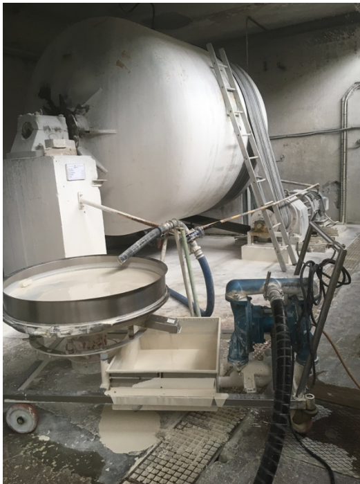
Figura 2.11. Moagem a húmido e peneiração do vidro.
