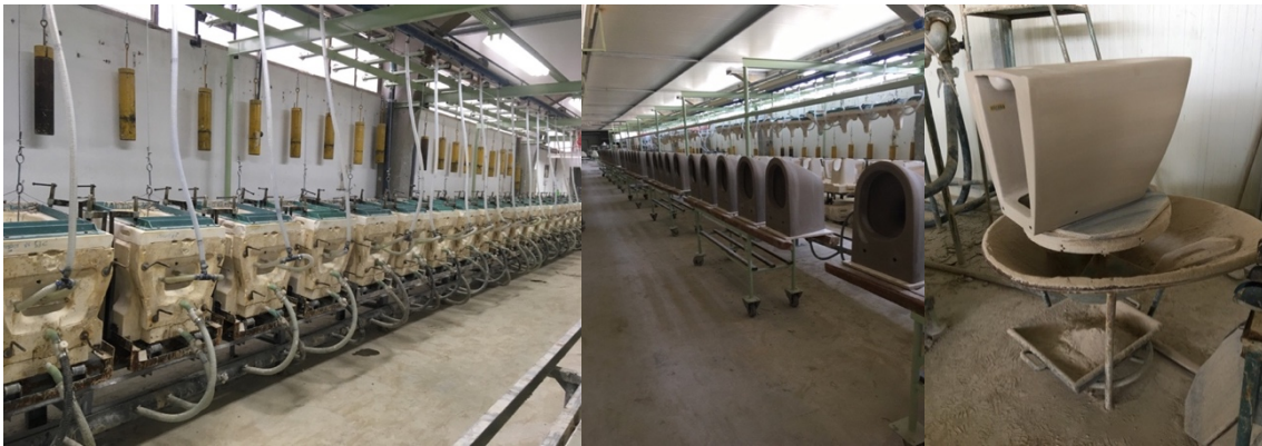
Figura 2.13. Enchimento do molde (lado esquerdo), peça desmoldada (centro) e respetivo acabamento (lado direito).
