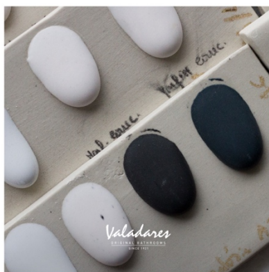
Figura 2.5. Teste de fusibilidade realizada ao vidrado [30] .
