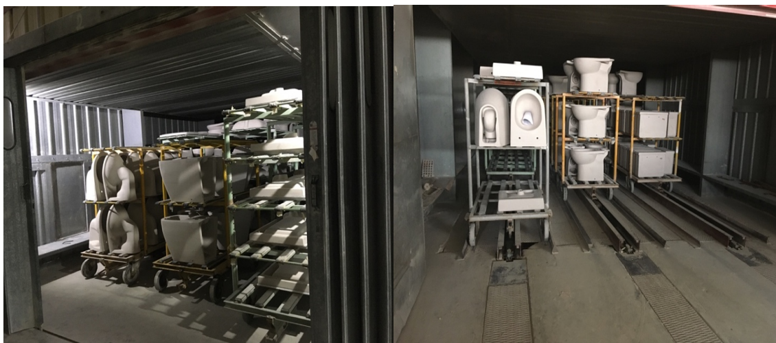
Figura 2.14. Processo de secagem das peças à entrada (lado esquerdo) e saída do secador (lado direito).
