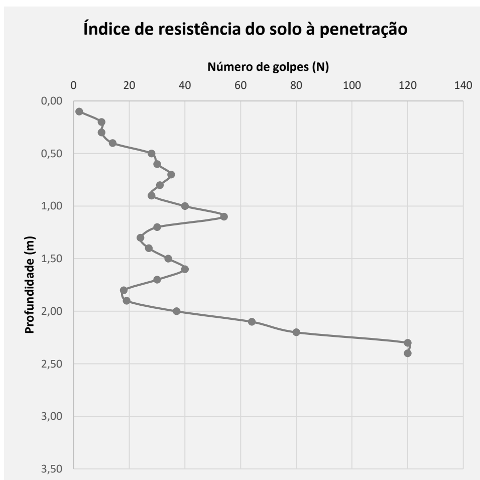
Figura 17 - Exemplo de um gráfico de índice de resistência do solo à penetração
