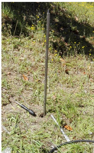
Figura 6 – Introdução de uma nova vara para dar continuidade ao ensaio
