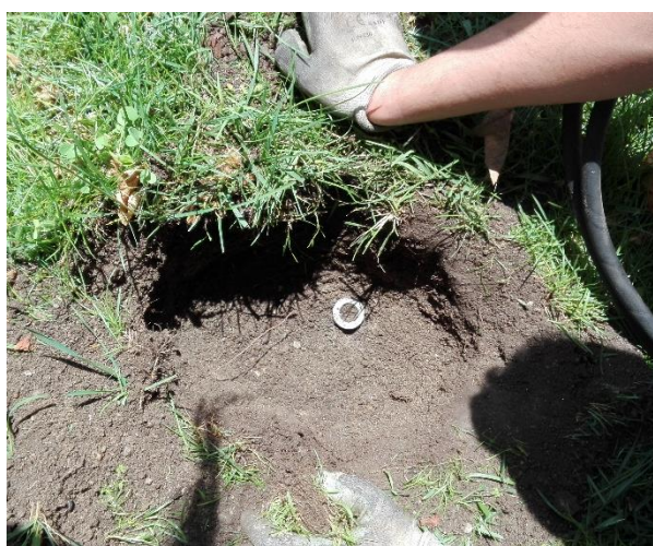
Figura 2 – Preparação do terreno e colocação da ponteira cónica no mesmo
