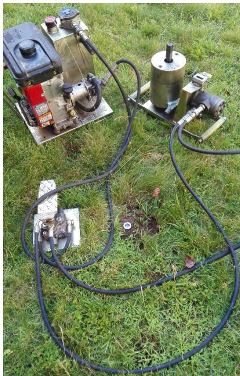
Figura 3 – Colocação adequada do motor, do pilão e do pedal para o começo do ensaio
