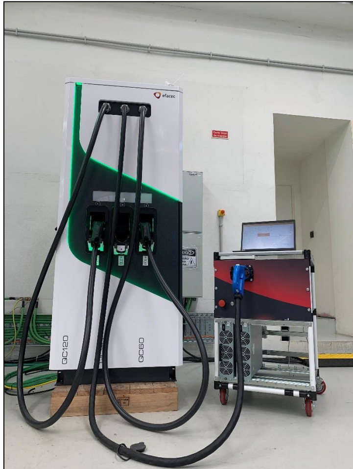
Fig. 37 - Ensaio do carregador de 120 kW com o simulador implementado
