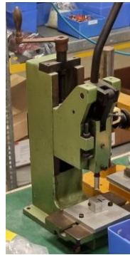
Figura 42 - Prensa da armadura
