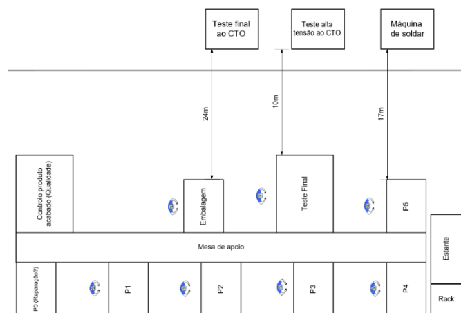
Figura 22 - Layout da linha com deslocações fora da linha
