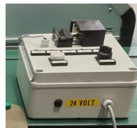
Figura 40 - Equipamento de verificação dos micro-switch
