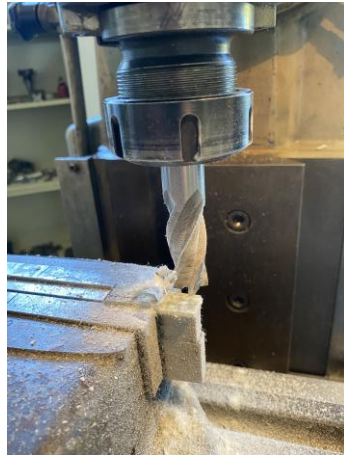
Figura 91- Maquinação de um lado do provete BS
