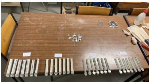
Figura 98- Colagem das dobradiças no primeiro lado dos provetes DCB
