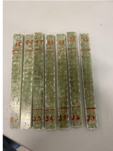
Figura 108- Marcação das áreas de amarração e identificação dos provetes de tração
