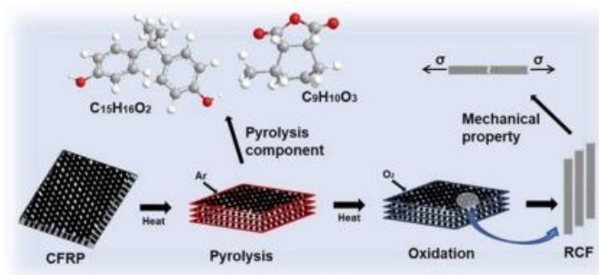
Figura 49- Processo de pirólise e oxidação de compósitos reforçados com fibra de carbono e matriz de resina epóxi [97]
