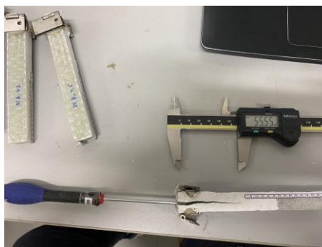
Figura 146- Medição da pré-fenda nos provetes DCB
