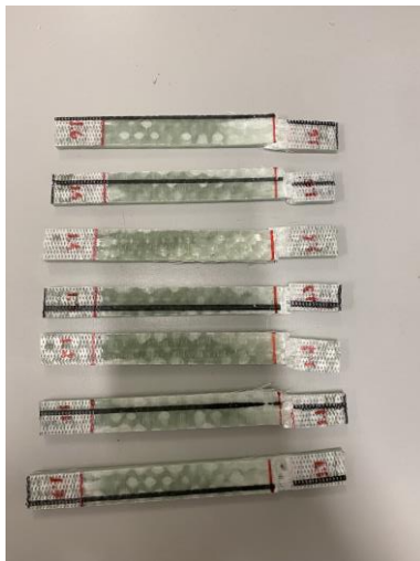
Figura 110- Provetes de tração da placa 1 após ensaios
