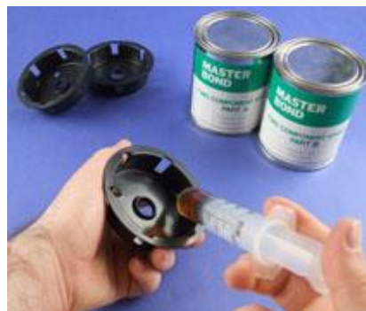
Figura 25- Resina epóxi utilizada para arranjo de componentes [33]
