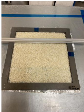
Figura 60- Deposição e nivelamento do PA na placa 3
