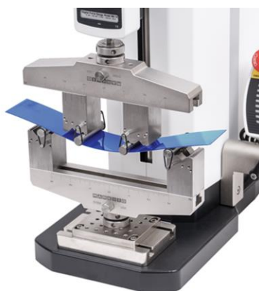
Figura 42- Realização de ensaio de flexão em 4 pontos [70]
