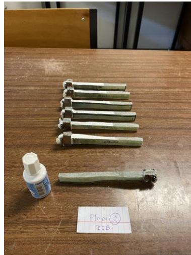
Figura 102- Pintura da face lateral dos provetes DCB com tinta corretora branca
