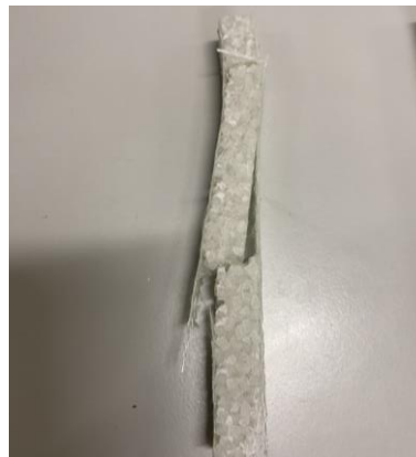
Figura 117- Pormenorização da rotura ocorrida num provete de tração da placa 4
