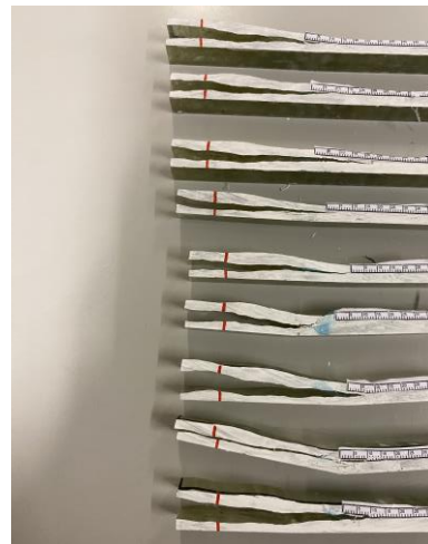
Figura 168- Provete ENF da placa 1 após ensaios Figura 169- Provete ENF da placa 2 após ensaios
