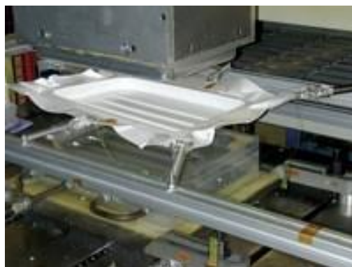
Figura 51- Termoformação de painéis de compósito [99]
