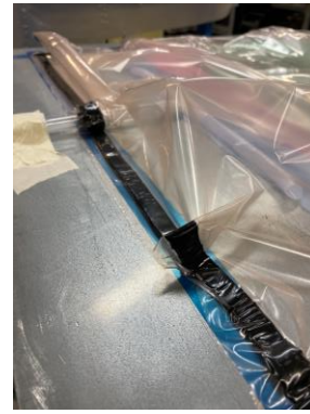
Figura 74- Pregas criadas no saco de vácuo
