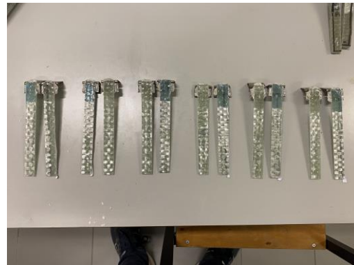
Figura 149- Demonstração da uniformidade de rotura dos provetes DCB da placa 1
