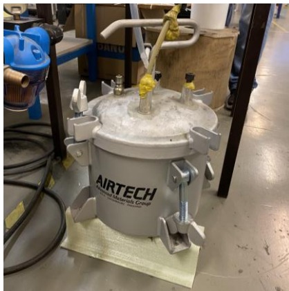
Figura 75- Reservatório de resina
