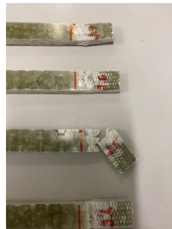
Figura 113- Pormenorização da rotura ocorrida nos provetes de tração da placa 2
