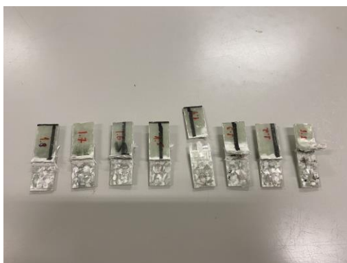
Figura 132- Provetes BS da placa 1 após ensaios
