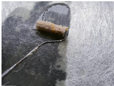
Figura 22- Uso de resina de poliéster em fibra de vidro [28]
