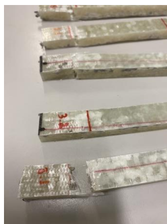
Figura 115- Pormenorização da rotura ocorrida nos provetes de tração da placa 3
