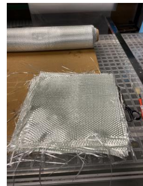
Figura 64- Camadas de fibra de vidro após corte
