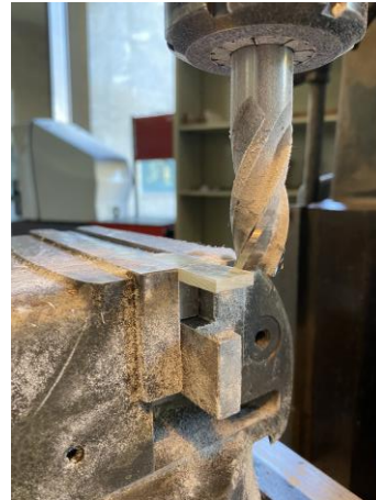
Figura 92- Maquinação do lado oposto do provetes BS
