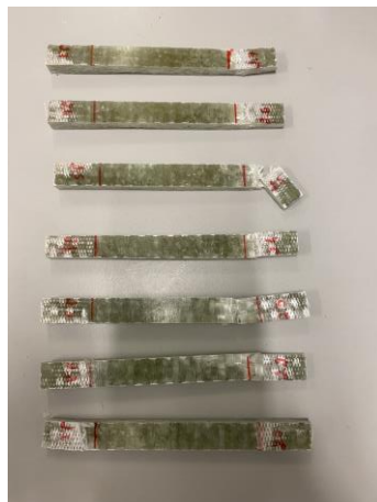
Figura 112- Provetes de tração da placa 2 após ensaios
