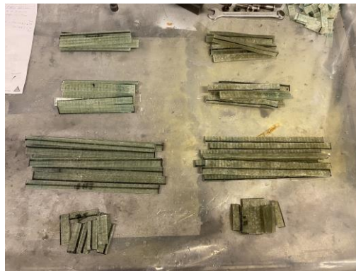
Figura 85- Provete final obtidos das placas 1 e 2
