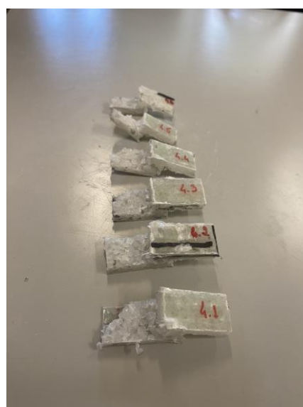
Figura 135- Provetes BS da placa 4 após ensaios
