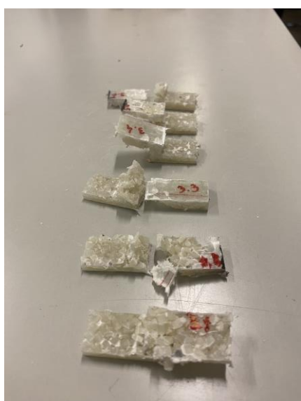
Figura 134- Provetes BS da placa 3 após ensaios
