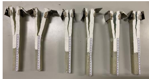
Figura 153- Visão geral dos provetes DCB da placa 3 após ensaios
