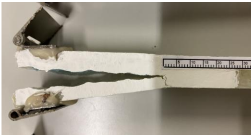
Figura 152- Pormenorização da rotura de um provete DCB da placa 3
