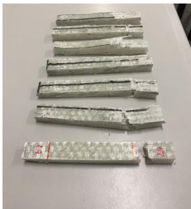
Figura 116- Provetes de tração da placa 4 após ensaios
