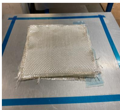
Figura 58- Camadas da placa 1 (apenas fibra de vidro)
