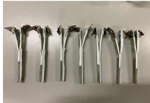
Figura 151- Visão geral dos provetes DCB da placa 2 após os ensaios
