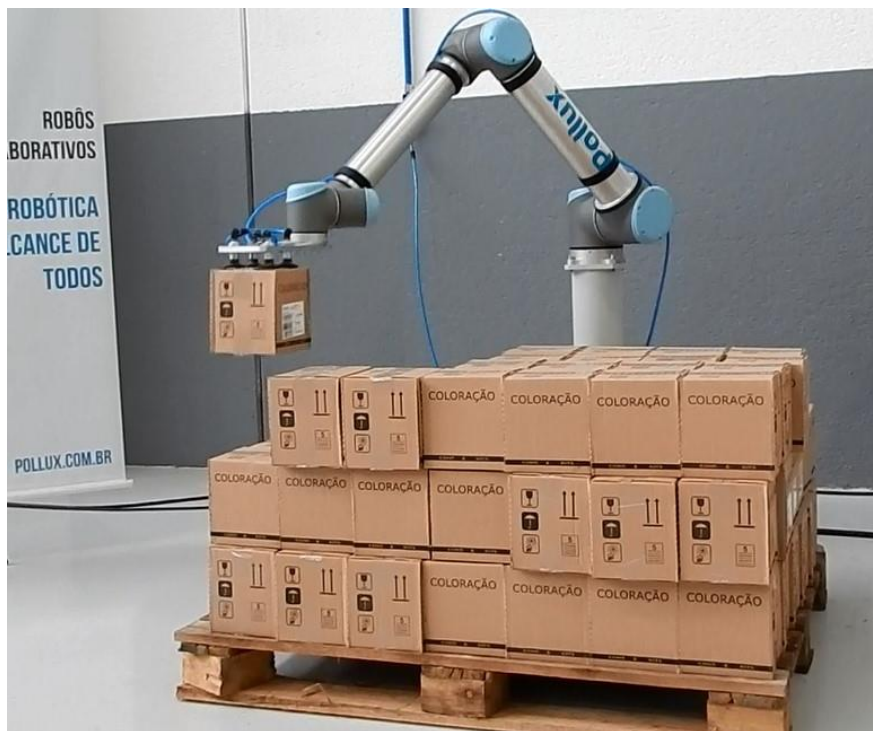
Figura 3 Braço robótico em trabalho de paletização
