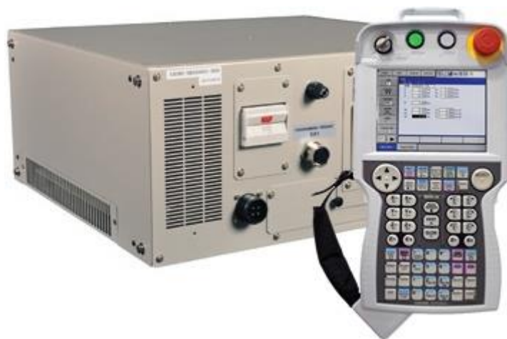
Figura 21 Controlador FS100 e consola de programação
