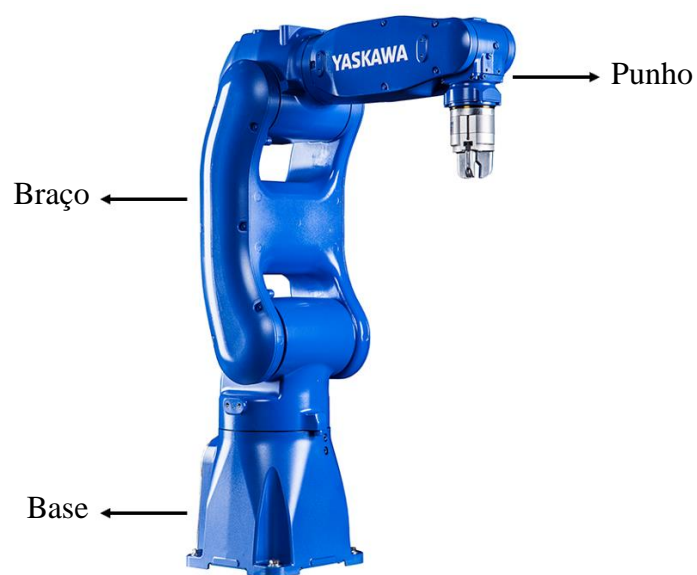
Figura 5 Partes principais de um braço robótico
