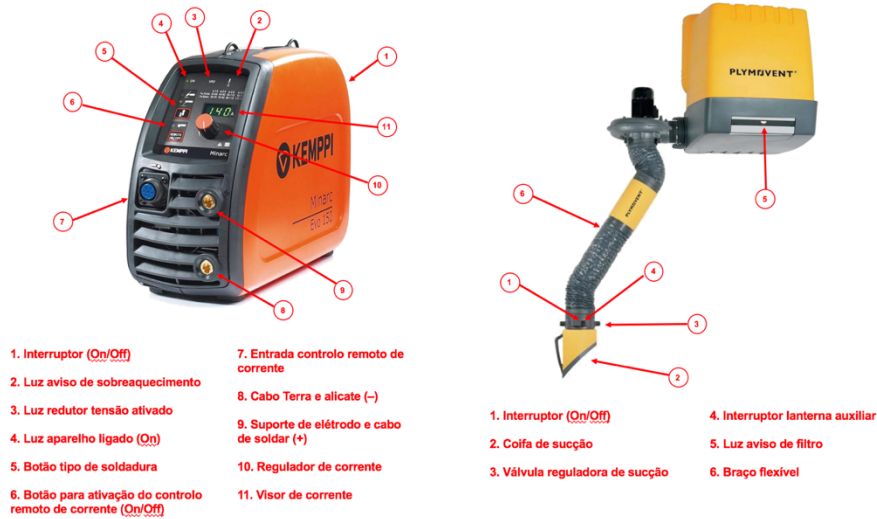
Figura 32 – One-Point Lesson do equipamento de soldadura e extrator de fumos.
