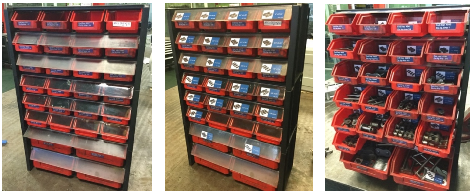
Figura 41 – Antes: a) módulo sem identificação e depois: b) módulo com identificação; c) módulo com kanban .
