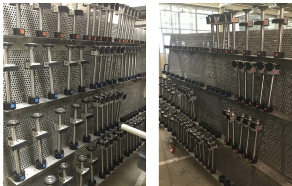
Figura 87 – Identificação das peças de formato da Rotuladora da linha 1.
