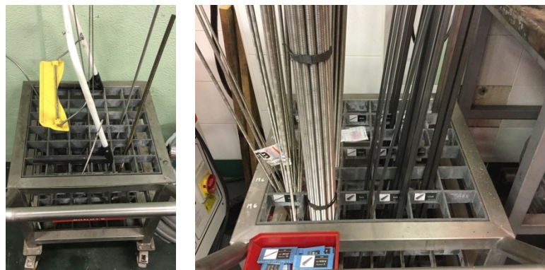
Figura 20 – Suporte de varão roscado: antes (à esquerda) e depois (à direita).
