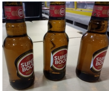
Figura 91 – Rótulos mal colados.
