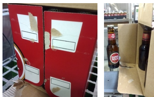
Figura 90 – Pontos de cola desafinados, cola vitrificada e cola visível no exterior da caixa.
