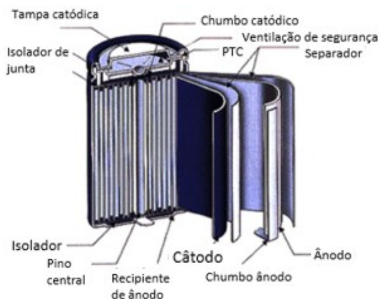
Figura 12 -Esquema traduzido da bateria de íon de lítio[10]
