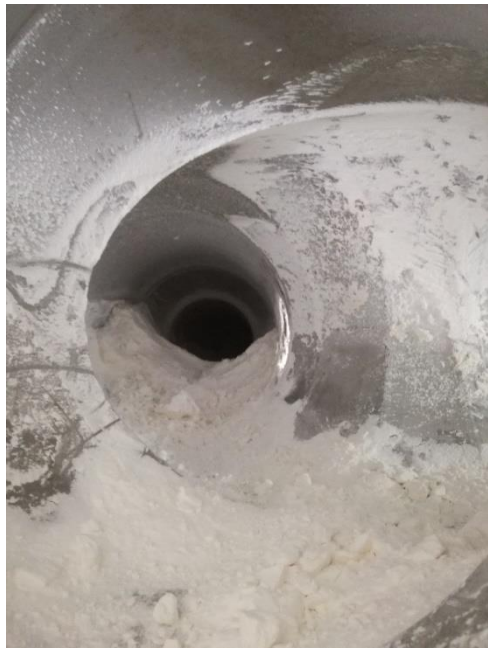
Figura A. 52 - Açúcar acumulado na bifurcação da linha principal
