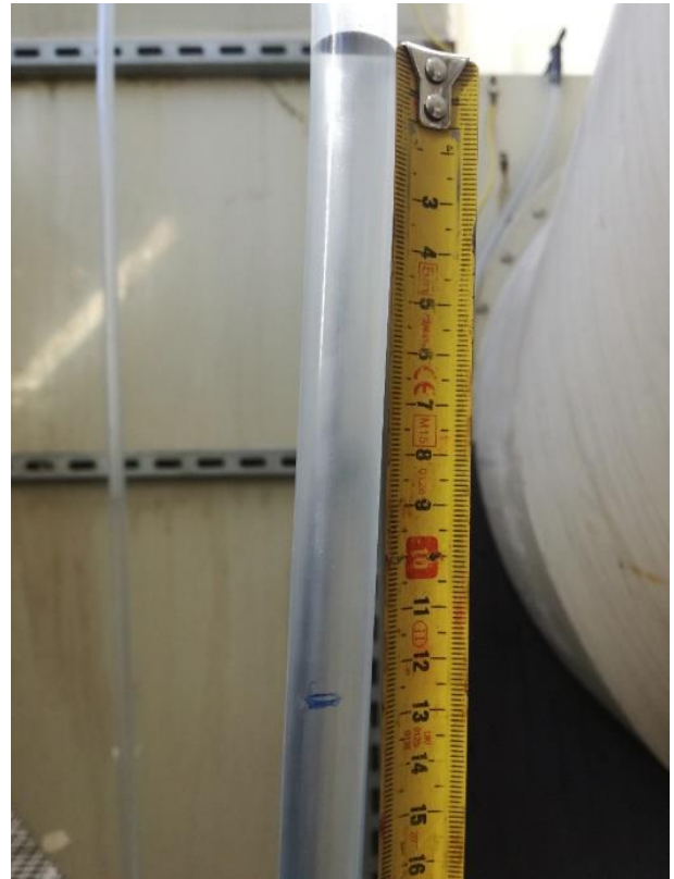
Figura A. 62 - Medição do desnível da água devido à diferença de pressões centrada no ventilador
