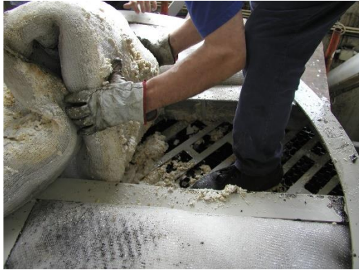
Figura A. 56 - Remoção do filtro colmatado
