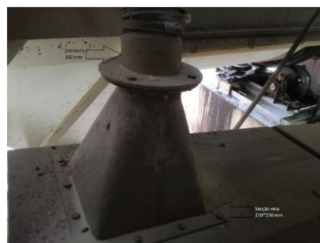
Figura A. 33 – Captação LS3B, na base do transportador de banda de ligação ao sem-fim de descarga do secador de 20 ton (TRBA 0163)
