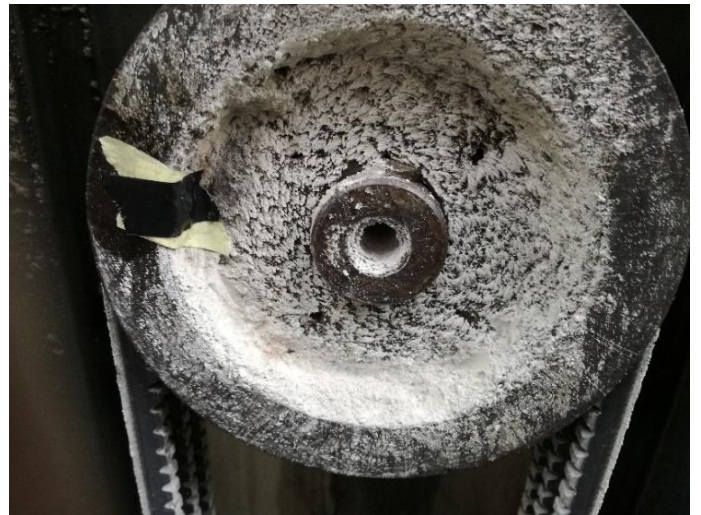
Figura A. 65 - Polia em repouso com duas tiras de papel para indicação visual
