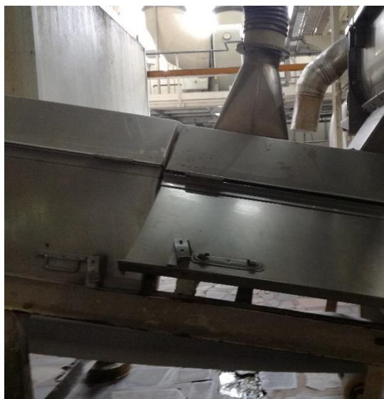
Figura A. 1 - Base do Transportador de bandas de ligação ao sem-fim de descarga secador 20 ton (TRBA 0163)
