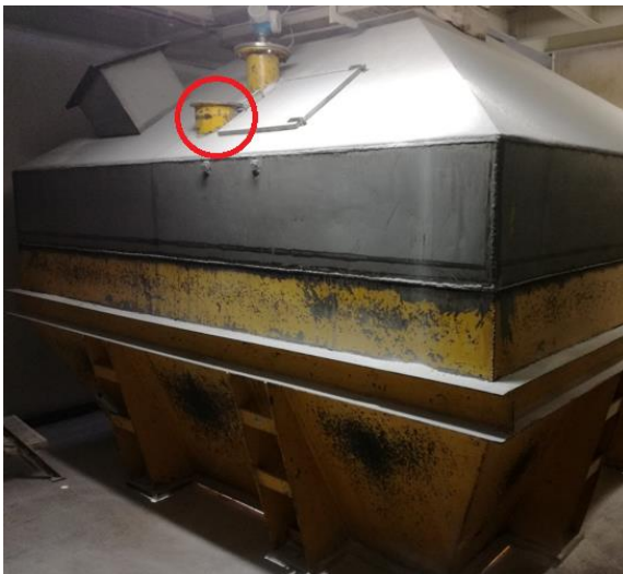
Figura A. 15 - Silo de açúcar de 20 ton (SILO 0037)
