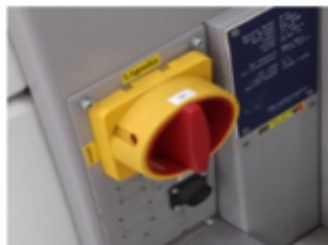
Figura 12 - Desligar o interruptor
