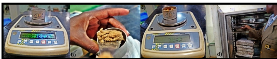
Figura.15. Processo para determinar o teor em água: a) peso da cápsula; b) adição da amostra na cápsula; c) pesar o conjunto; d) colocar a amostra na estufa para secagem (Ferreira, 2021).
