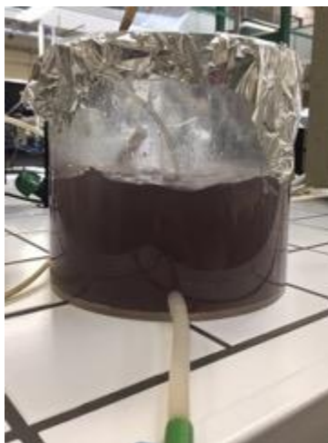
Figura 5-16 Instalação experimental de arejamento prolongado
