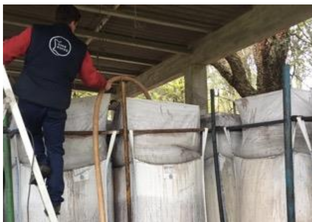
Figura 3-17 Adição das lamas húmidas em sacos grandes por parte de um operador da ETAR
