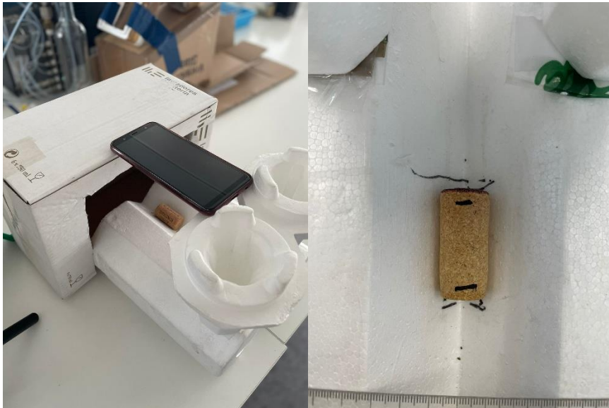
Figura 4.5 – Fotografia da montagem para obtenção das fotografias, à esquerda, e da imagem obtida, à direita.
