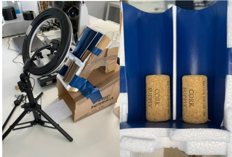
Figura 4.9 – Fotografia do novo suporte para obtenção das fotografias, à esquerda, e da imagem obtida, à direita.
