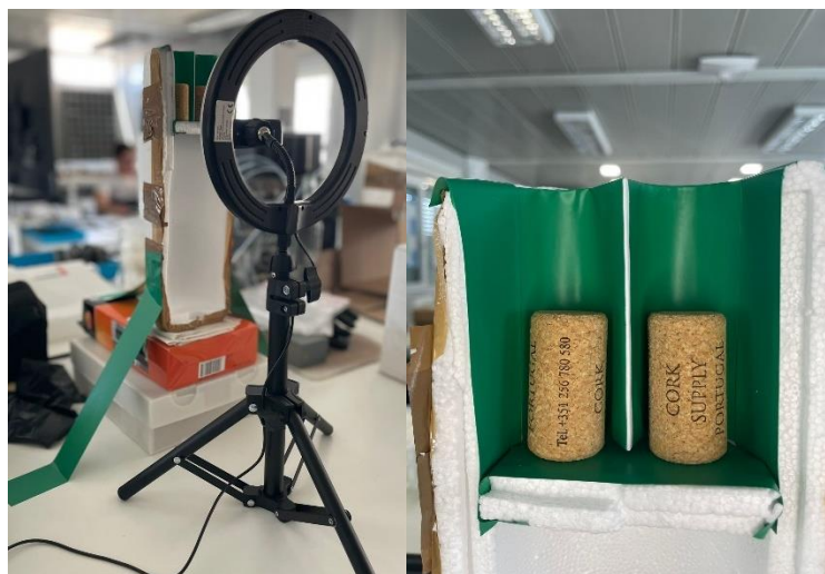
Figura 4.10 – Fotografia do novo suporte para obtenção das fotografias, à esquerda, e da imagem obtida, à direita.
