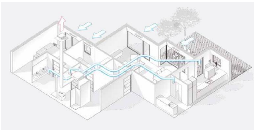
Figura 7 - Sistema VMC de simples fluxo (Soler&Palau, 2023)
