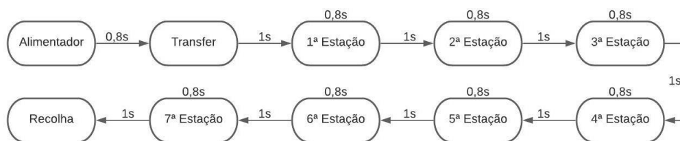
Figura 47 - Fluxograma da produção do arame
