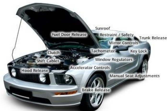
Figura 5 - Cabos de comando existentes num veículo automóvel [13]
