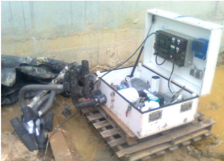
Figura 35 – Sistema utilizado na realização do TRT.
