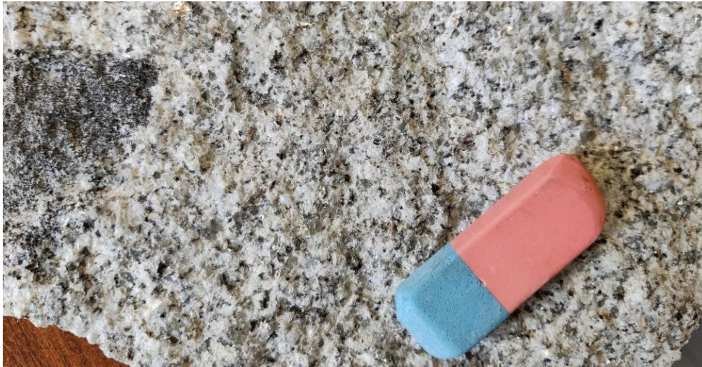
Figura 43 - Composição da matriz rochosa: quartzo, plagioclase, biotite e moscovite. Na esquerda da amostra observa-se xenólito.
