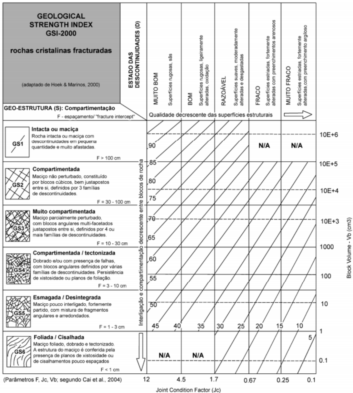
Figura 21 - Ábaco para a estimativa de GSI/2000 para rochas cristalinas fraturadas (adaptado de Marinos & Hoek, 2000; Cai et al., 2004; Santa et al., 2019).
