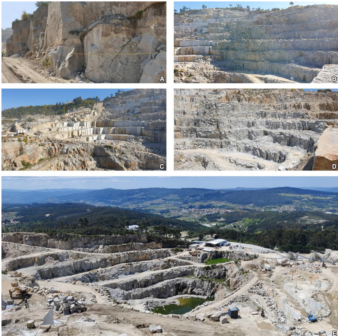
Figura 40 - A) Exemplo da técnica da amostragem linear (Scanline – SC01); B) Perspetiva da transição da exploração de rocha ornamental e agregados (NE); C) Vista da exploração de rocha ornamental (NW); D) Panorama da exploração de agregados (SC04, SC05, SC06 e SC07); E) Vista aérea do sul da Pedreira do Poço Negro (maio de 2022).
