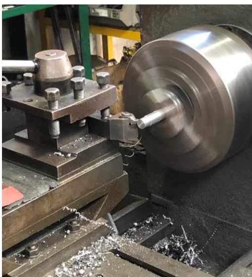
Figura 60 - Fabrico dos casquilhos a colocar no gabari
