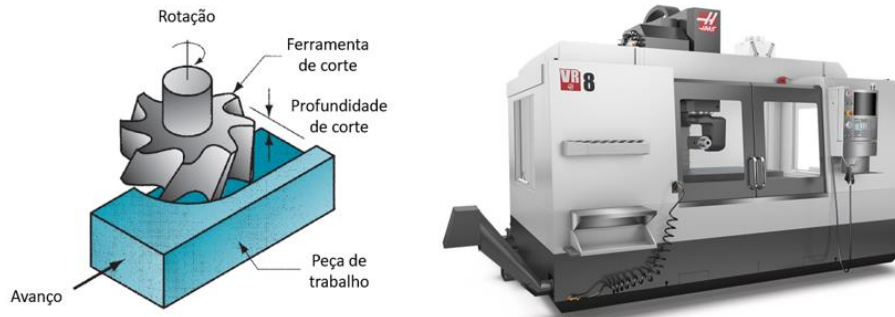
Figura 11 - Ilustração de uma operação típica de fresagem (à esquerda) e uma fresadora (à direita) [8, 23].
