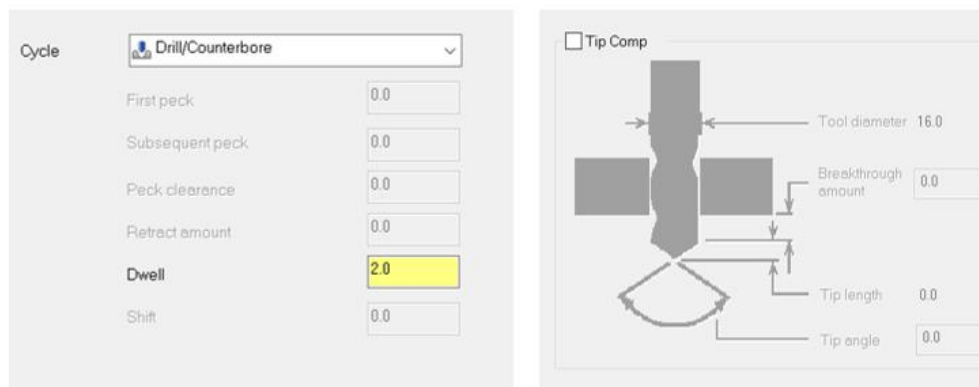
Figura 59 - Estratégia de furação (à esquerda) e desativação da compensação da ponta da ferramenta (à direita) do mandrilamento das cavilhas.
