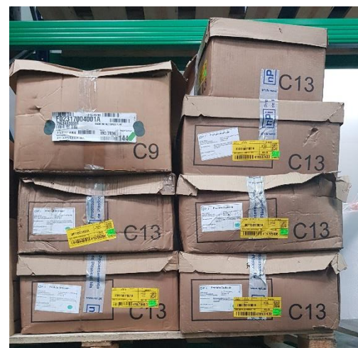
Figura 29 - Embalagens de cartão danificadas devido a humidade.
