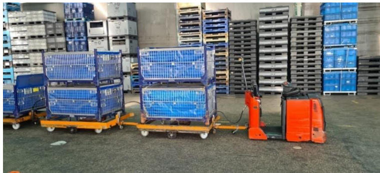
Figura 70 - Teste para validação de transporte de embalagens empilhadas.
