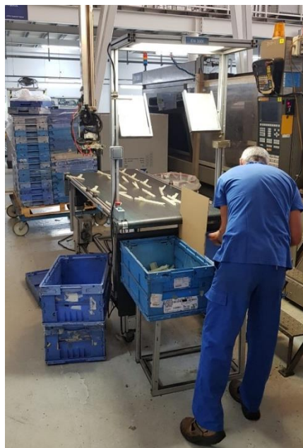
Figura 76 - Máquina de injeção com um tapete transportador dedicado.
