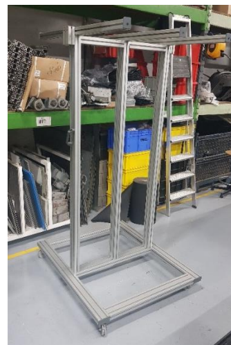
Figura 61 - 1º Protótipo da estrutura em alumínio.
