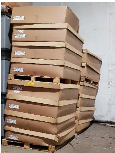
Figura 28 - Embalagens de cartão danificadas devido a mau armazenamento.
