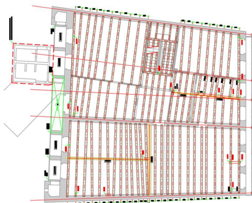
Figura 3.17 - Projeto estrutural do piso 1 (Edifício 12)
