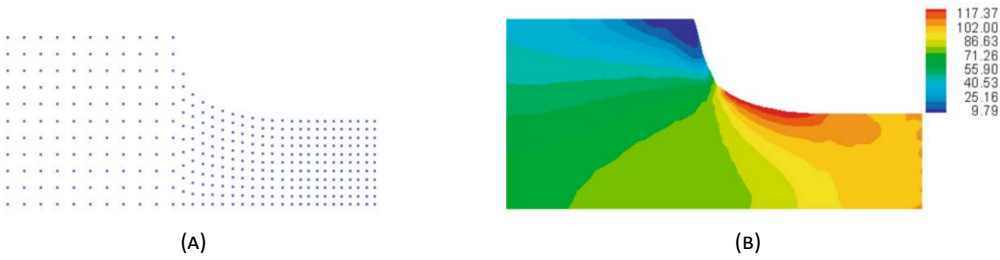
FIGURA 3.8: Visualização de otimização obtida por Zou et al. 2007 no exemplo 1: (a) Distribuição de nós (b) campo de tensões de Von Mises
