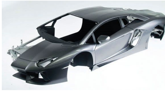
FIGURA 4.6: Protótipo de um quadro monocoque e o body , em escala 1/6 (Mackay 2016)
