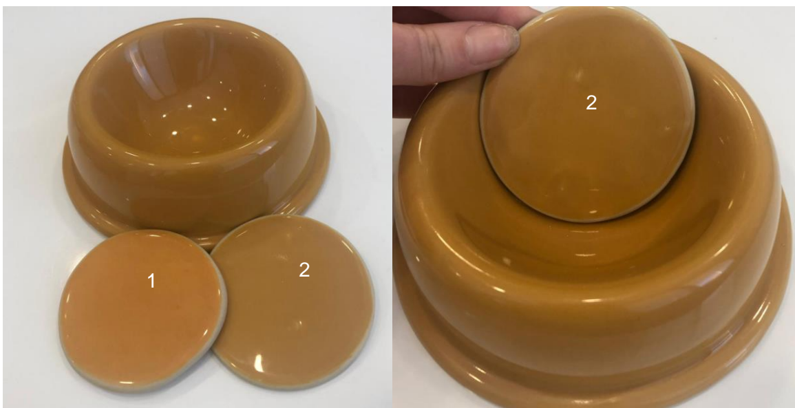
Figura 5.24- Vidrado cerâmico como resultado da formulação com a peça cerâmica.
