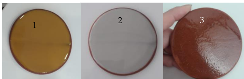
Figura 5.18- Vidrados aplicados em terracota para controlo de qualidade.
