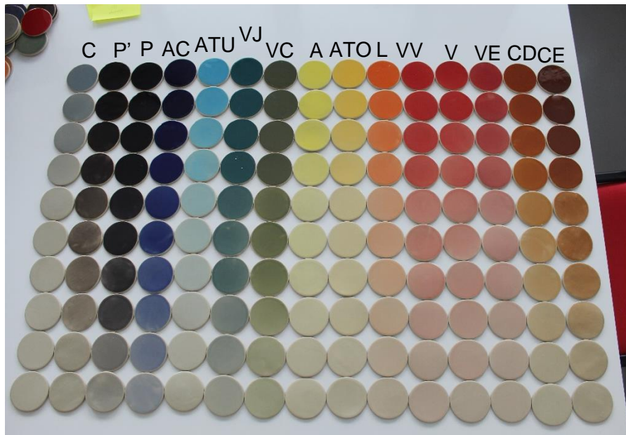
Figura 5.4- Resultados dos vidrados cerâmicos na pasta de grés para a criação do database, com a base AQQ 10434.
