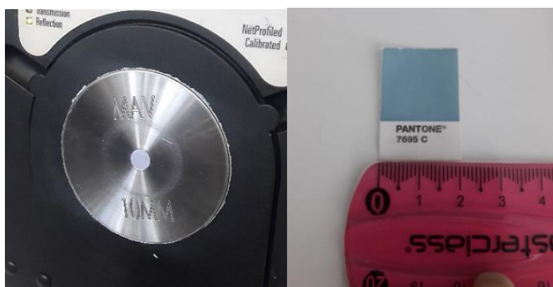
Figura 4.14- a) Abertura de 10 mm; b) Exemplo de um PANTONE para leitura (dimensões de 20 x 20 mm).
