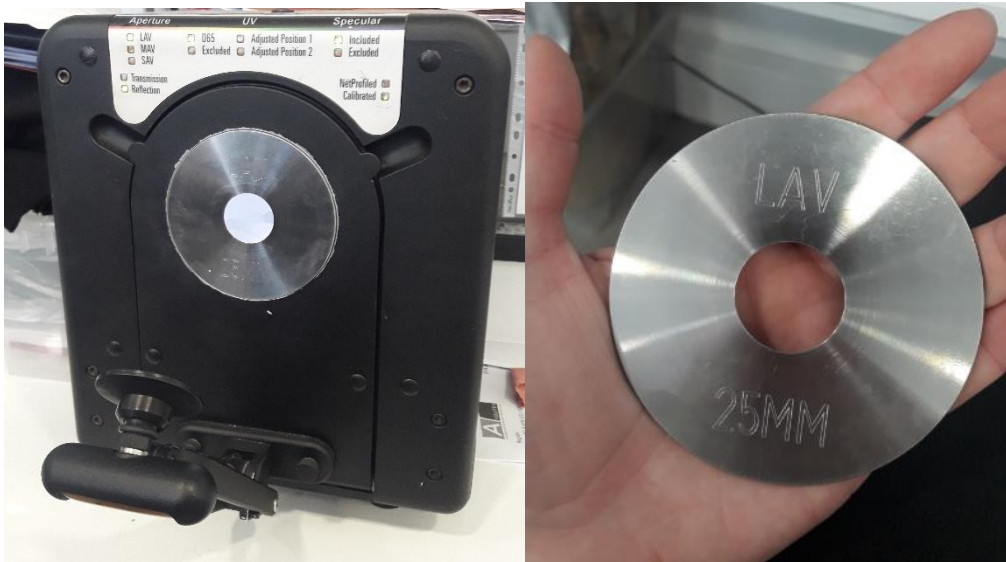
Figura 4.6- Espectrofotómetro X-rite Color i5, da Neurtek Instruments (à esquerda) e abertura utilizada para leitura das amostras (à direita).
