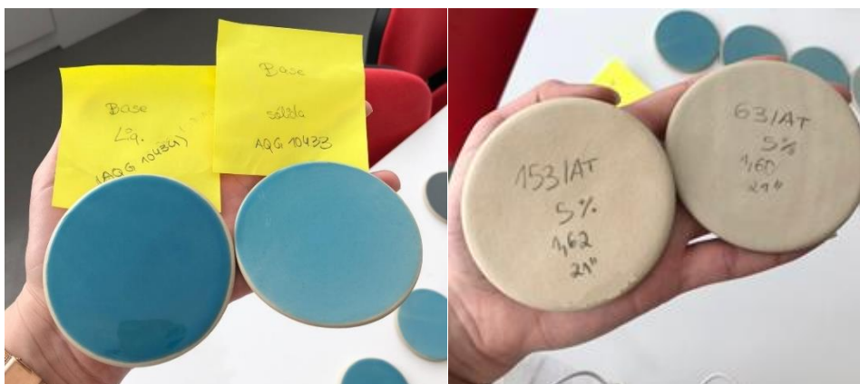
Figura 5.5- Vidrados cerâmicos em grés, com a base AQQ 10433 e AQQ 10434 e o corante ATU.
