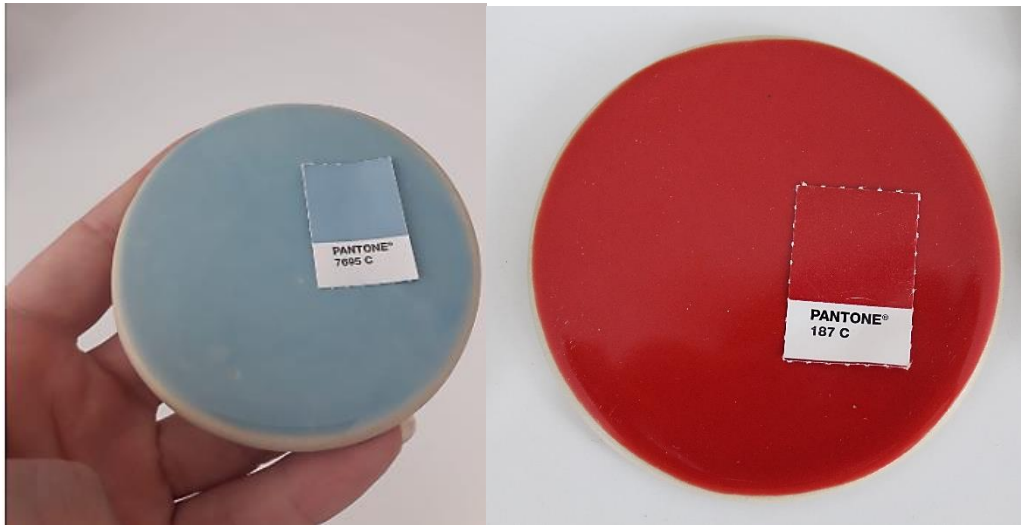
Figura 5.20- a) Vidrado cerâmico como resultado da formulação com o PANTONE 7695 C; b) Vidrado cerâmico como resultado da formulação com o PANTONE 187 C.
