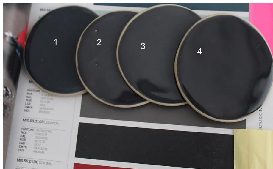
Figura 5.22- Vidrado cerâmico como resultado da formulação com a cor da revista “ Liquorice ”, equivalente ao PANTONE 19-0910 TPG.
