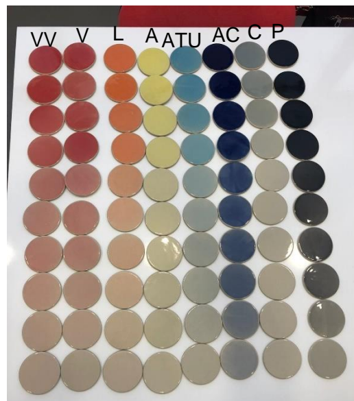
Figura 5.2- Resultados dos vidrados cerâmicos na pasta de grés para a criação do database , com a base AQG 10433.
