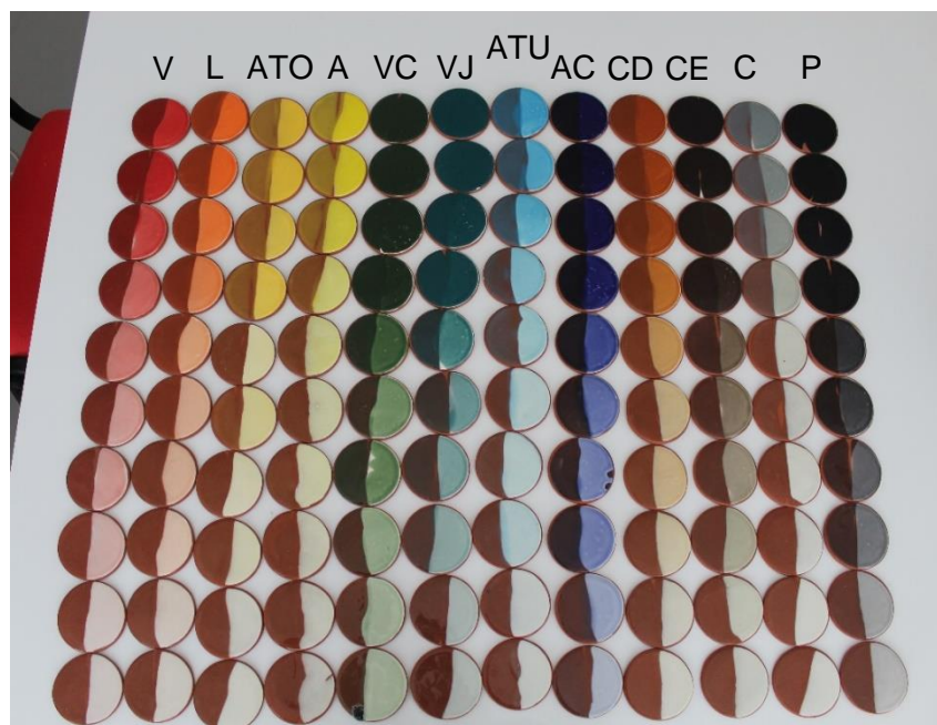
Figura 5.12- Resultados dos vidrados cerâmicos na pasta de terracota para a criação do database, com a base AQV 504 (do lado direito encontra-se o vidrado aplicado sobre o engobe e do lado esquerdo encontra-se o vidrado aplicado diretamente na pasta).
