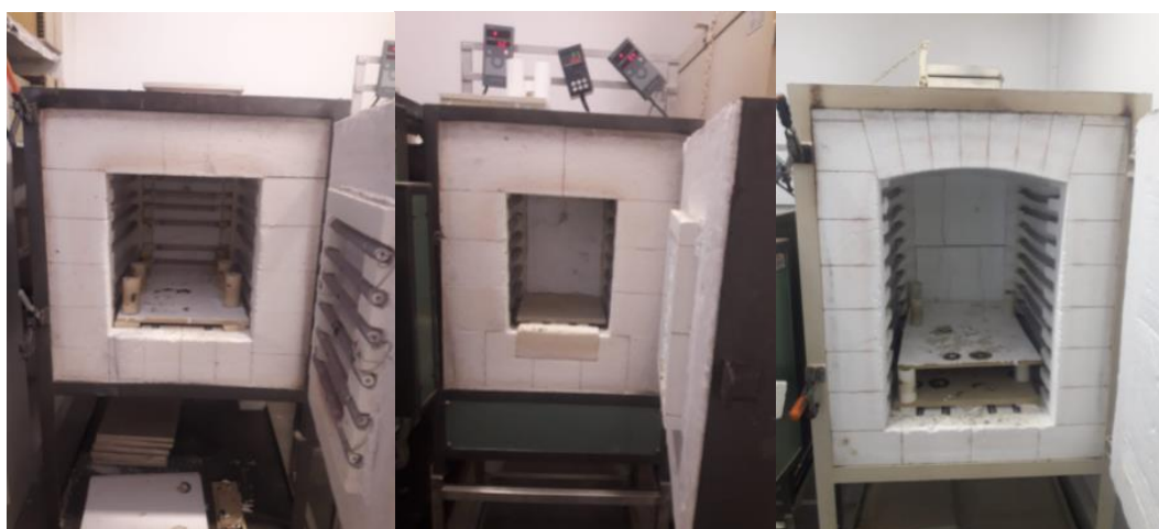
Figura 4.4- Fornos de cozedura: forno de “baixa temperatura” (à esquerda) para peças de faiança e de terracota, forno para peças de porcelana ou outras que necessitem de um controlo de temperatura rigoroso (imagem do meio) e forno de “alta temperatura” (à direita), para peças de grés.
