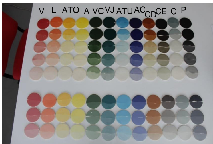
Figura 5.8- Resultados dos vidrados cerâmicos na pasta de faiança, para a criação do database, com os dois tipos de bases.
