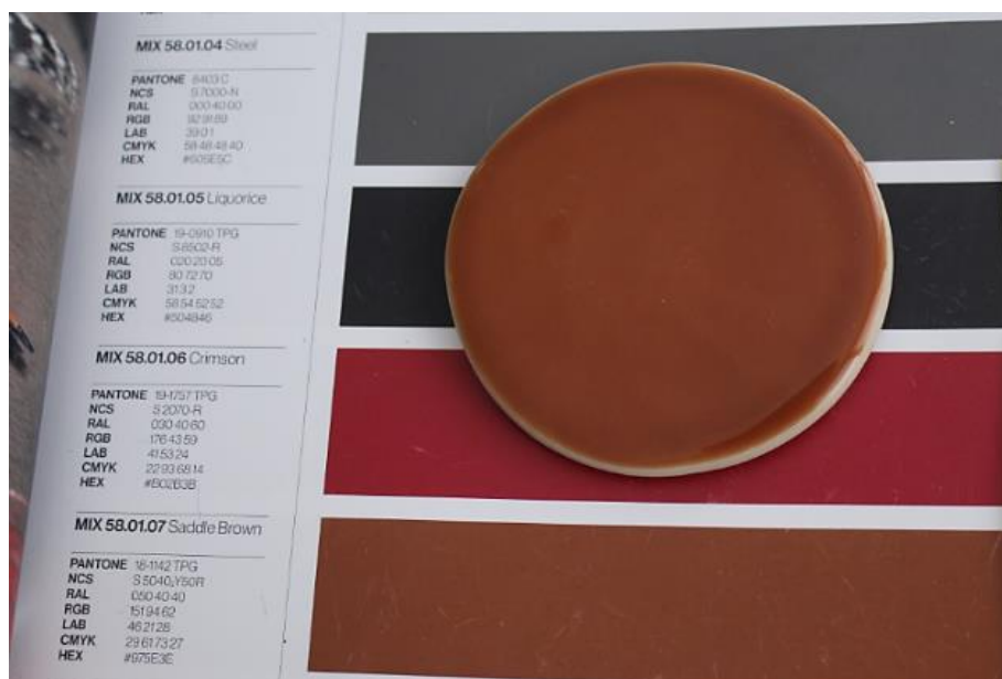
Figura 5.21- Vidrado cerâmico como resultado da formulação com a cor do catálogo “Saddle Brown”, equivalente ao PANTONE 18-1142 TPG.
