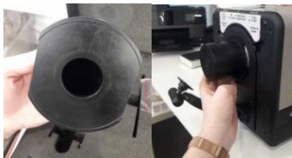
Figura 4.9- Calibração com a peça preta.
