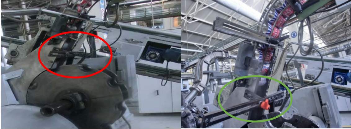
Figura 46-Aplicação dos apertos rápidos (Antes e Depois)
