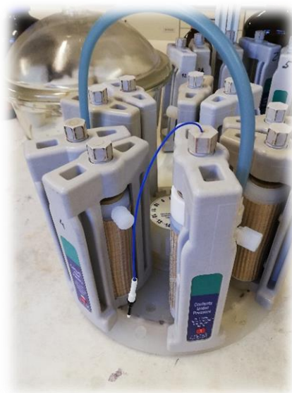
Figura 3.4. Vasos de extração microondas contendo as amostras, evidenciando-se o vaso de controlo contendo as sondas de temperatura e de pressão
