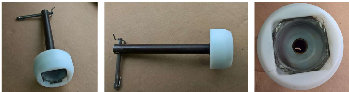
Figura 26 – Implementação do conjunto chave e capas de isolamento
