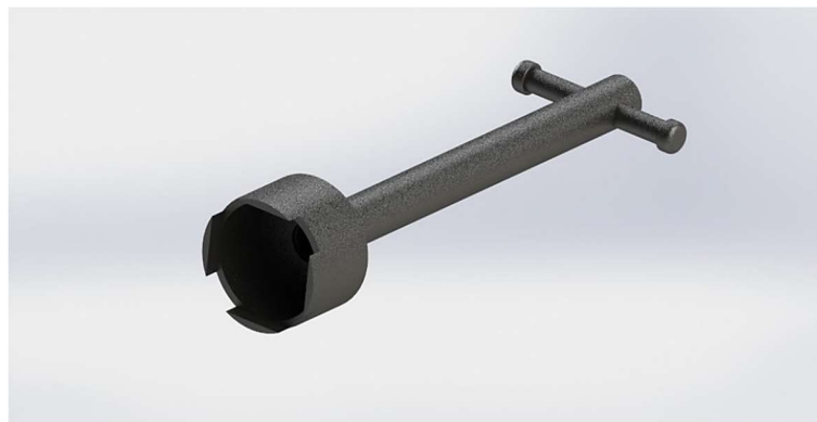
Figura 21 – Desenho 3D da chave de desapertar/apertar as roldanas
