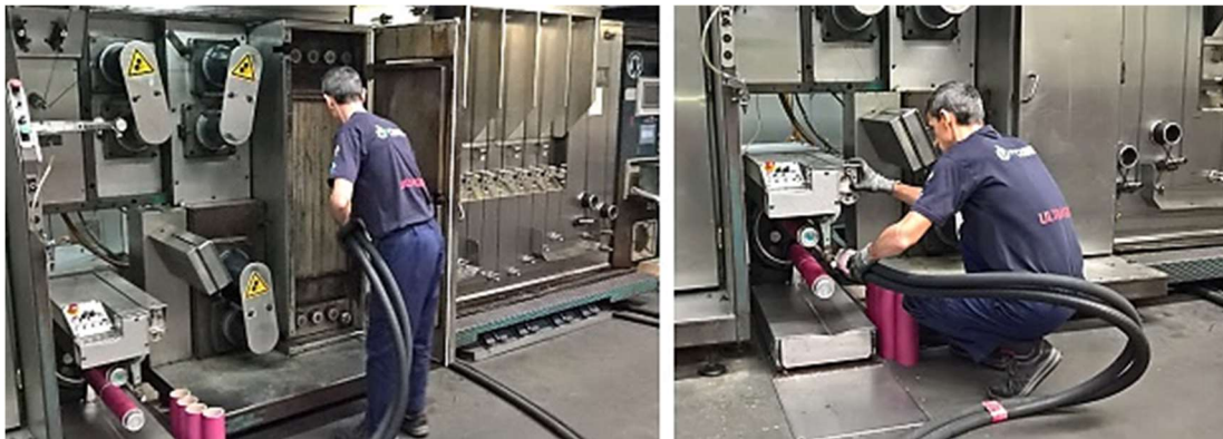
Figura 9 – Operação de engate do fio na bobinadora
