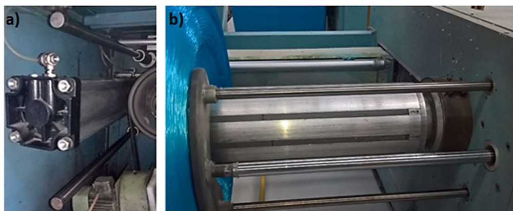
Figura 32 – a) Implementação do novo cilindro pneumático e guias b) Curso do novo extrator
