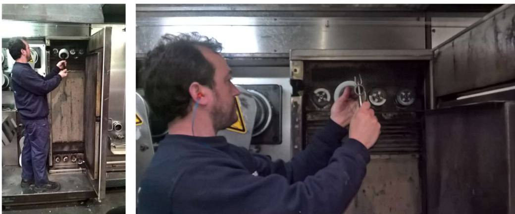
Figura 30 – Substituição da roldana no forno de pré-estiragem com a nova chave
