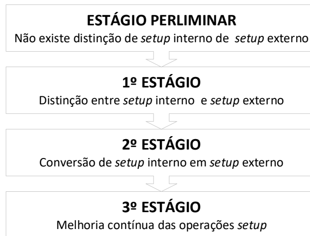
Figura 2 – Estágios de implementação da metodologia SMED. Adaptado de Shingo (1985)
