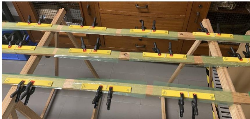
Figura 61 - Sessão de preparação de juntas PETG com Araldite® 2015
