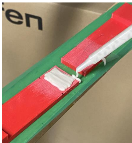
Figura 59 - Aplicação de adesivo Araldite® 2015
