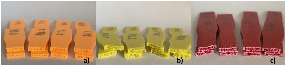
Figura 42 - Secções dos provetes bulk após rotura: a) PLA; b) PETG e c) ABS
