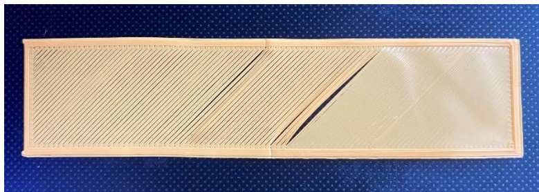
Figura 37 - Exemplo de má adesão após retirada da mesa de impressão
