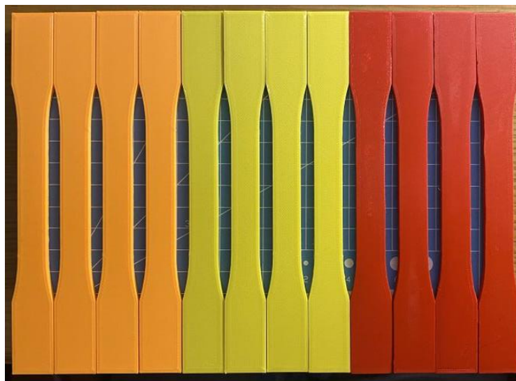
Figura 38 - Provetes bulk (PLA laranja à esquerda; PETG amarelo ao centro; ABS vermelho à direita)
