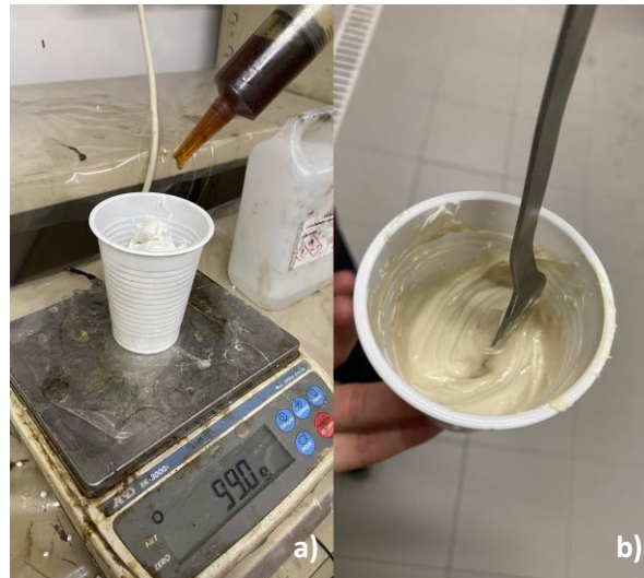
Figura 60 - Preparação de adesivo Sikaforce® 7752: a) pesagem de 100 g de resina e aplicação do endurecedor; b) mistura homogênea dos componentes
