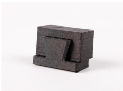
Figura 25 - Exemplo de encaixe fabricado por FDM [82]
