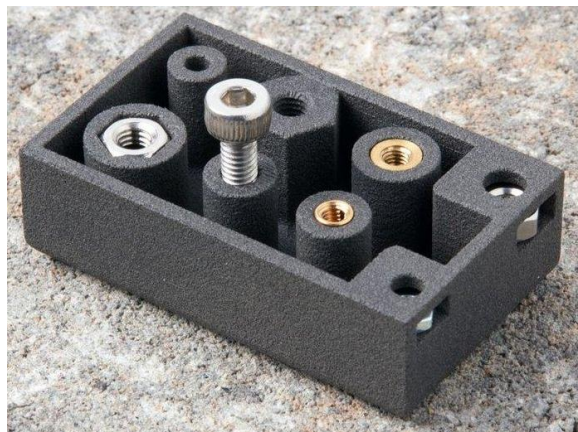
Figura 27 - Componente fabricado por AM pelo processo PBF com diferentes métodos de rosca [83]
