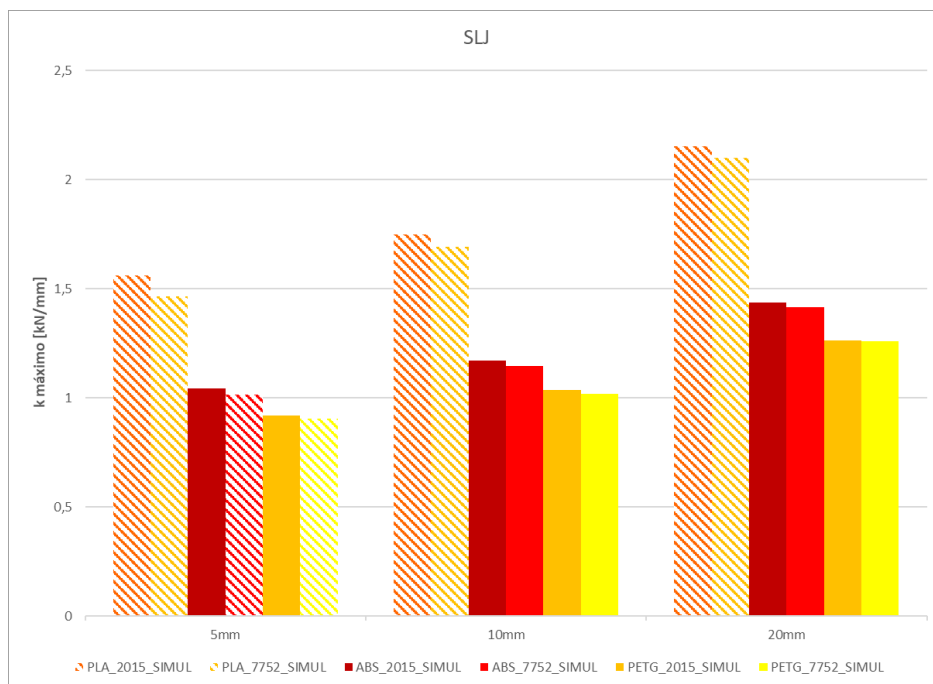
Figura 114 - Valores de k_{m\acute{a}x} [kN/mm] em função de L_0 por adesivo e aderente para a geometria SLJ; cor sólida = rotura aderente; tracejado = rotura coesiva no adesivo
