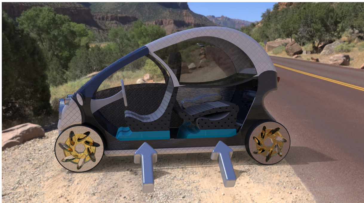
Figura 4.13: Localização das baterias em módulos por baixo dos assentos.
