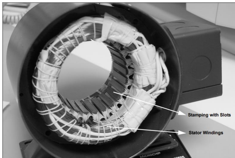
Figura 14 - Estator de um motor BLDC [28]
