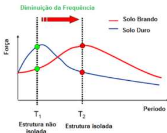
Figura 3.4 - Influência do solo na eficácia do sistema de isolamento (Santos, 2008).
