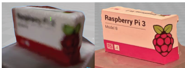
Figura 1 – Comparação de Texturas entre o sistema Sense 3D (à esquerda) e RaspBerry Pi (à direita)
