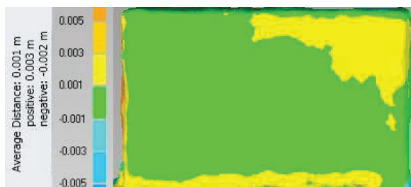
Figura 2 – Espectro do Desvio médio do objeto entre o sistema Sense 3D e RaspBerry Pi
