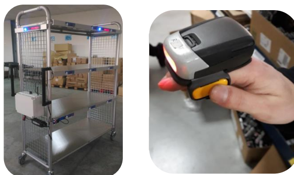
Figura 46 - Exemplo de solução Picking-to-Light .
