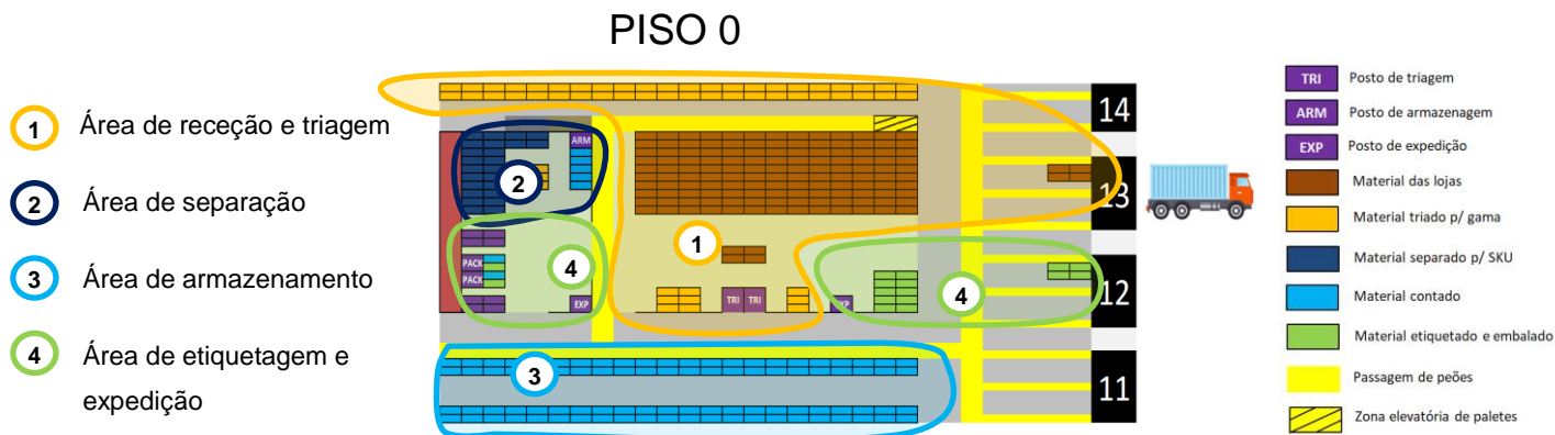
Figura 28 - Figura do Piso 0 da Mezzanine.
