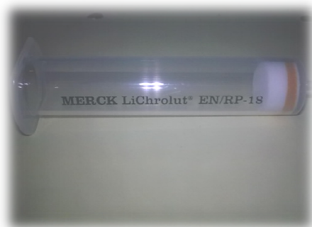
Figura 3.4 Coluna de SPE Lichrolut® EN/RP-18 com 6 mL de volume
