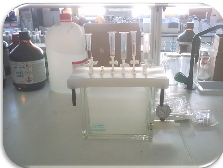
Figura 3.9 Manifold utilizado no procedimento de Extração
