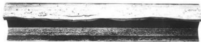
Fig. 4.24 - Esmagamento da cabeça do carril (Sousa, 2015)
