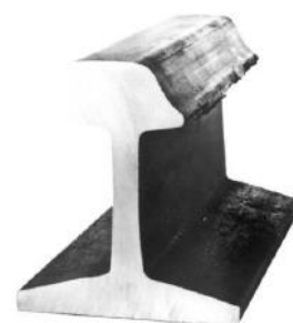
Fig. 4.26 - Desgaste lateral (Couto, 2008)
