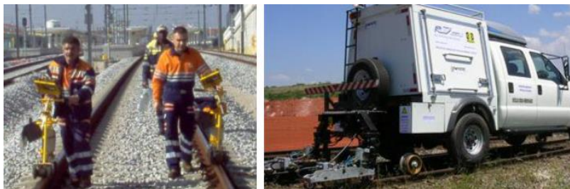
Fig. 9.9 - Ultrassom, auscultação ultrassónica de carris (Silva, 2012)
