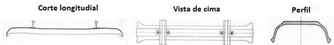
Fig. 4.5 - Travessa metálica (Nabais, 2015)
