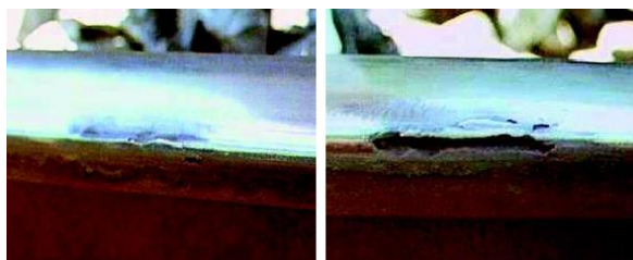
Fig. 4.30 - Descascamento lateral da cabeça do carril (Sousa, 2015)
