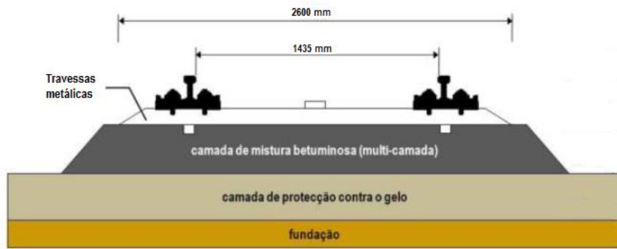
Fig. 4.43 - Esquema transversal da solução SATO (Paixão e Fortunato, 2009)
