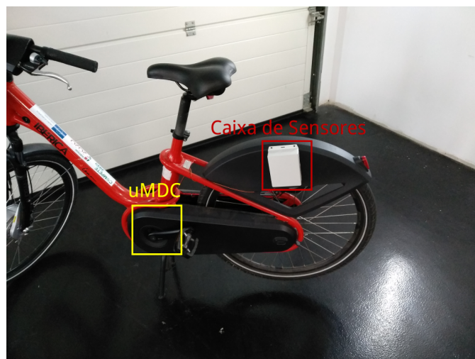
Figura 7.1: Caixa de Sensores instalada na bicicleta elétrica
