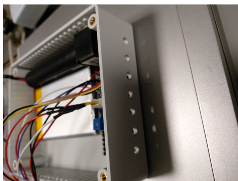
Figura 6.6: Caixa de sensores furos para entrada de ar
