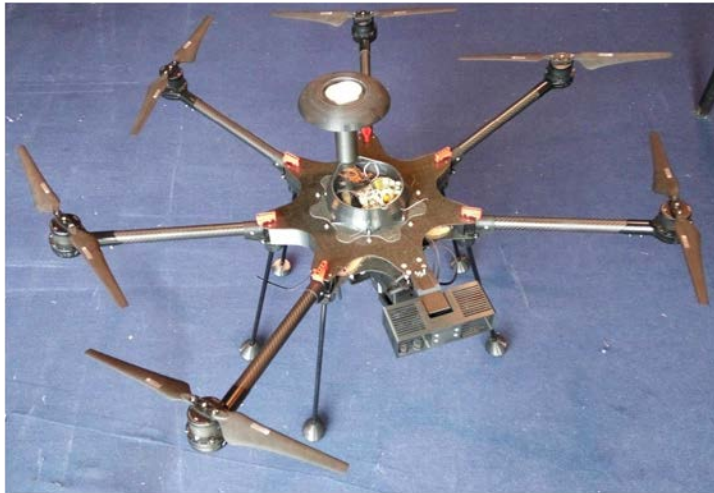
Figura 2.7: Versão V1 do UAV para inspeção de ativos elétricos da parceria INESC TEC/EDP Labelec
