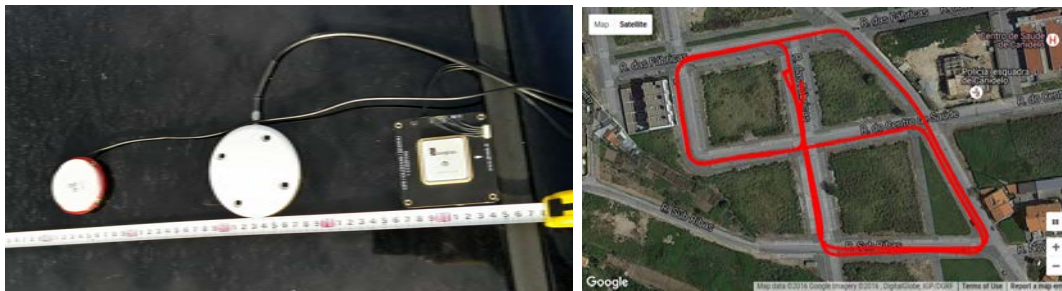
Figura 4.80: Disposição das antenas no tejadilho do carro, à esquerda, e percurso realizado durante o ensaio, à direita
