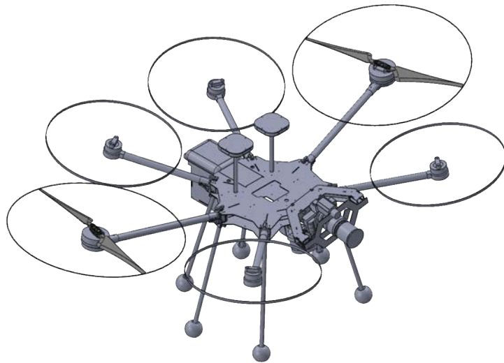
Figura 2.8: Versão V2 do UAV para inspeção de ativos elétricos da parceria INESC TEC/EDP Labelec
