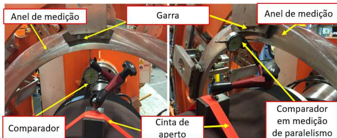
Figura 32 - Montagem de equipamentos de medição de concentricidade e paralelismo entre CTU e SM (antes)
