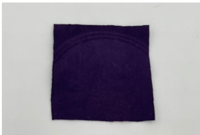
Figura 5.7: Tingimento de PLA a roxo em laboratório.
