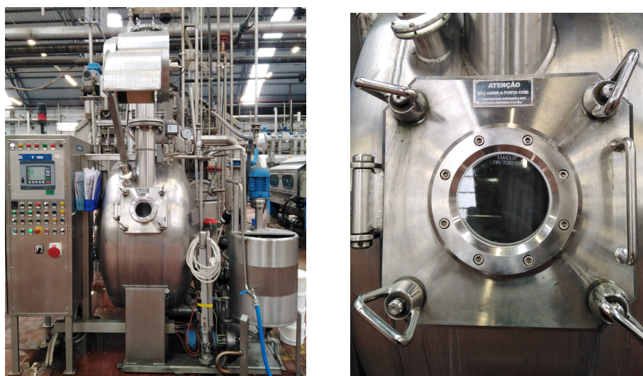
Figura 5.13: Máquina de tingimento, "Jet".
