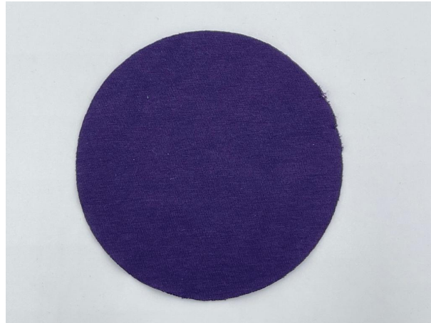
Figura 5.20: Tingimento em PLA a roxo a escala industrial.
