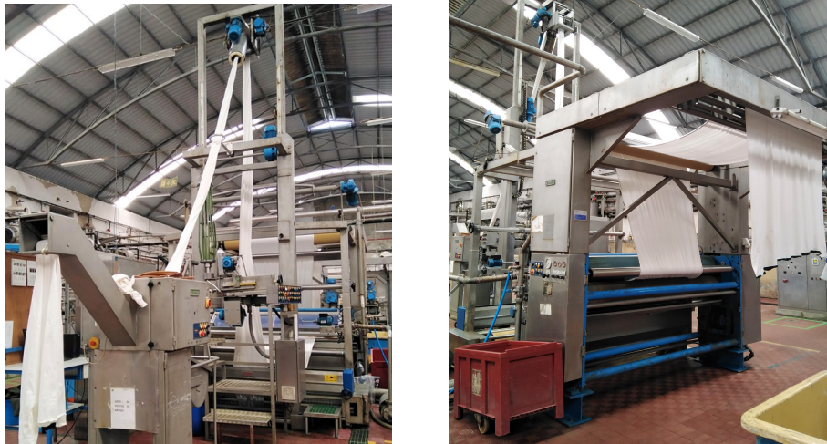
Figura 5.14: Máquina de abrir e espremer.
