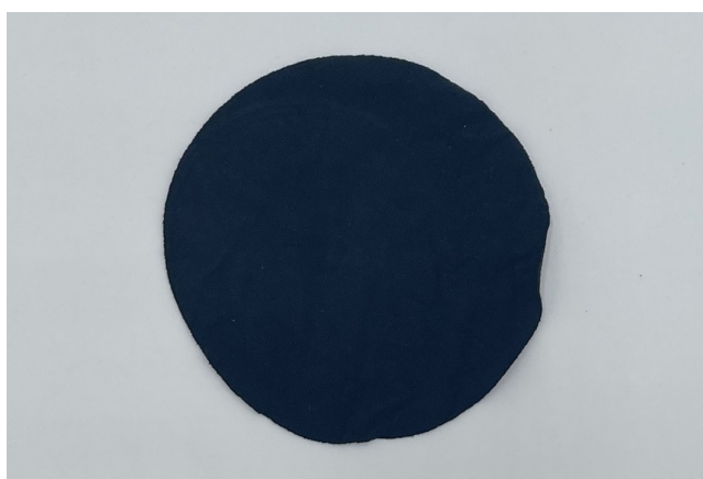
Figura 5.10: Poliéster tingido a preto a escala industrial.
