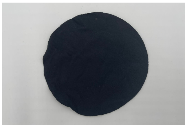
Figura 5.4: Poliéster tingido a preto em laboratório.
