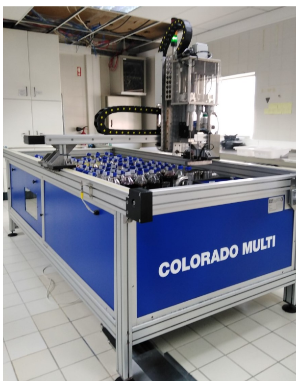
Figura 5.2: Máquina de pipetagem automática.
