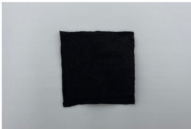
Figura 5.6: PLA tingido a preto em laboratório.
