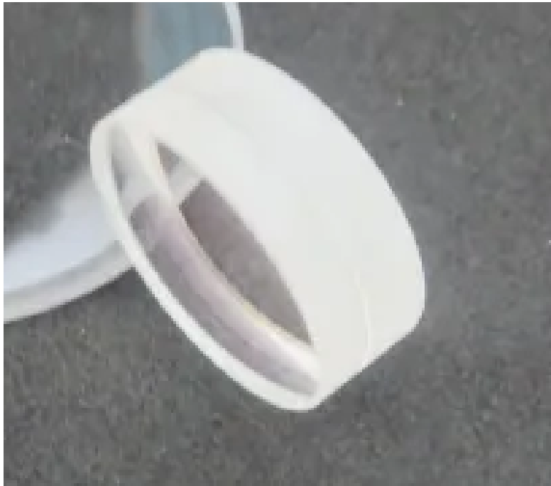
Figura 3.3: Lente com duas superfícies óticas coladas.
