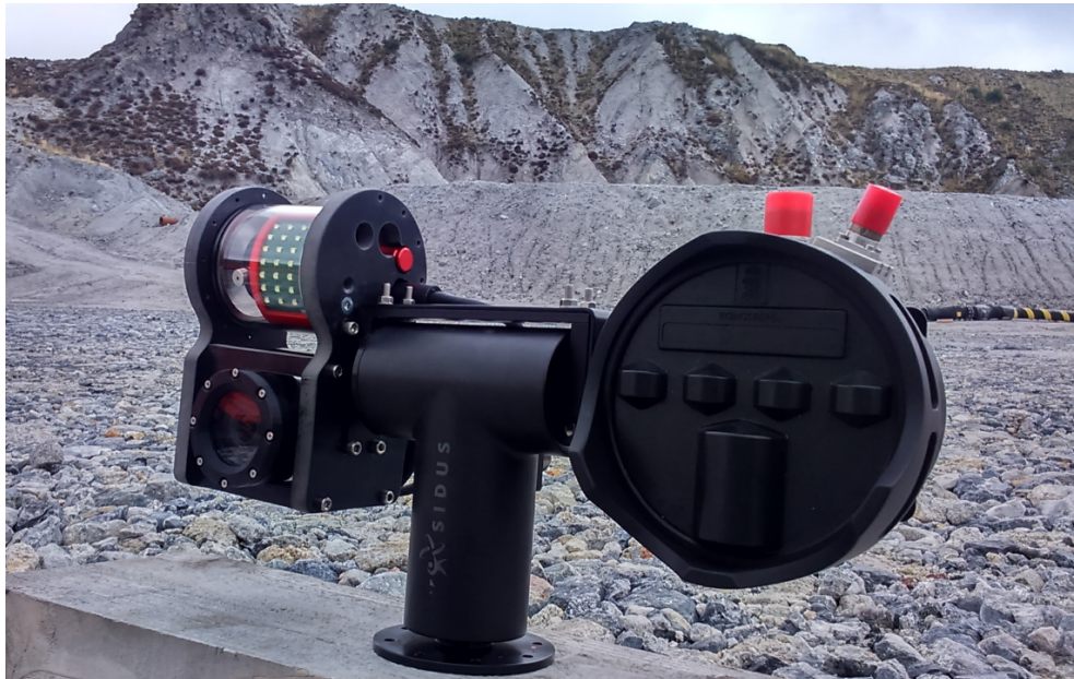
Figura 4.7: Pan & Tilt com um multibeam M3 (lado direito)
