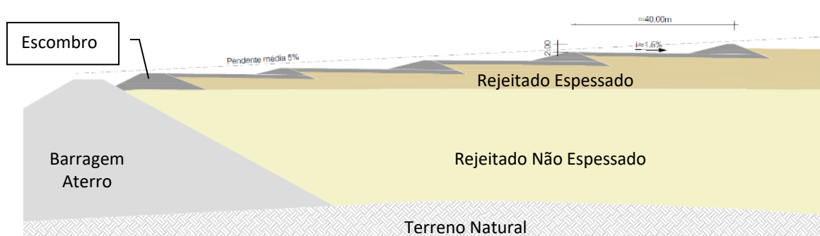
Figura 47. Corte Esquemático do Empilhamento Vertical na IRCL
