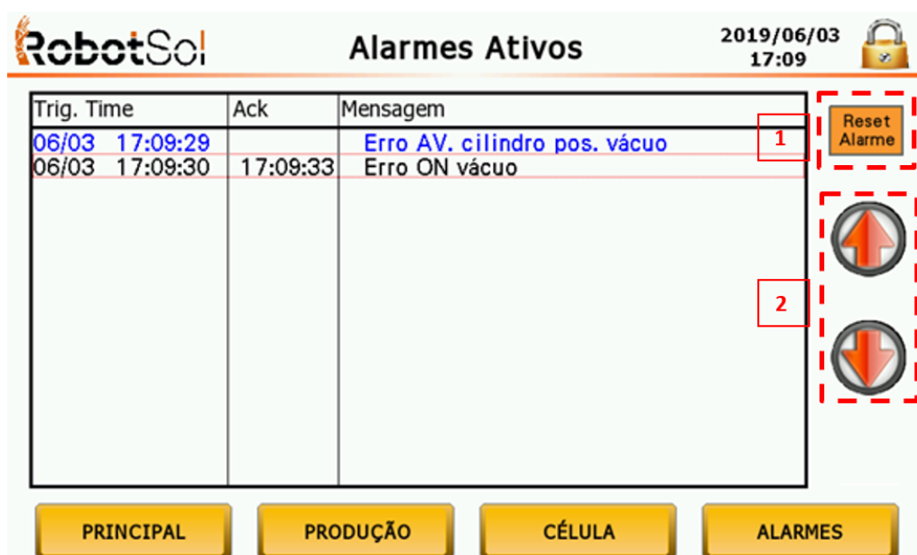
Figura 6.24: Consola HMI: ecrã de alarmes.
