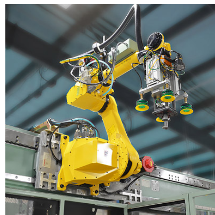
(b) Garra de sucção aplicado em robô FA-NUC [52].
