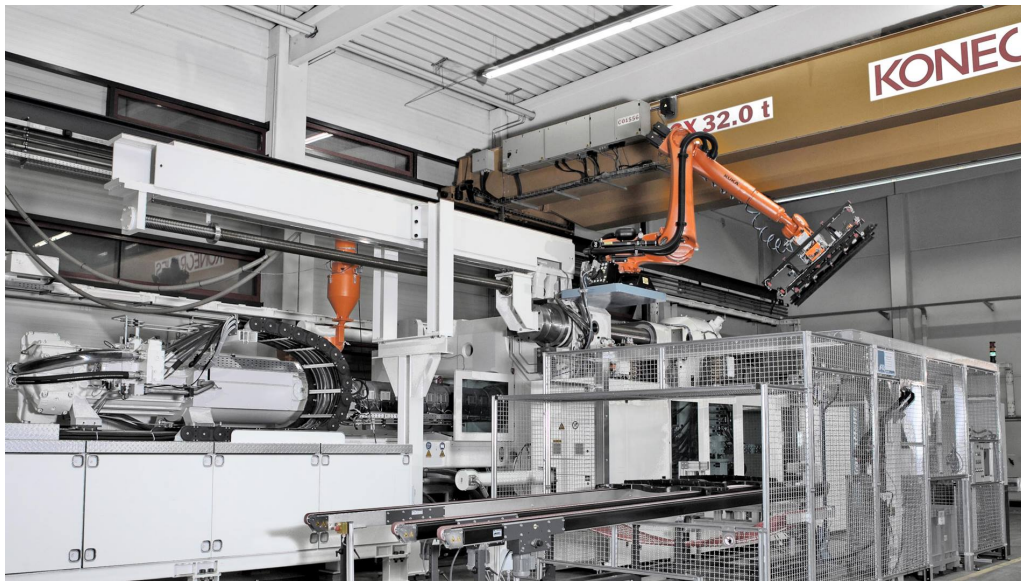
Figura 4.2: Solução apresentada pela KUKA para efetuar carga e descarga de máquina [53].
