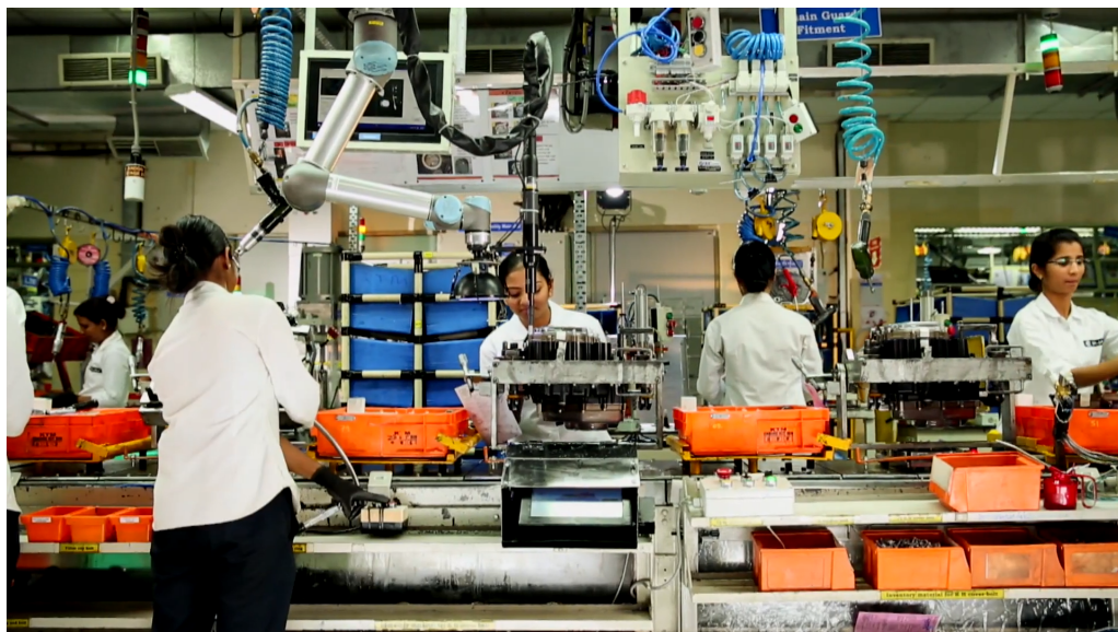
Figura 4.4: Robô colaborativo compacto, aplicado no teto, efetuando aparafusamento [55].
