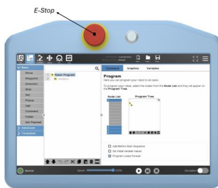
Figura 60 - Botão de emergência (E-Stop) presente no Teach Pendant
