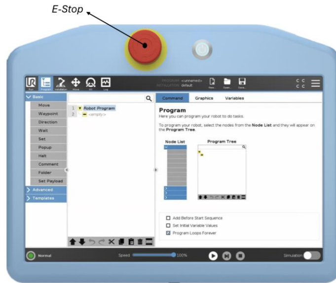
Figura 1 - Botão de emergência ( E-Stop ) presente no Teach Pendant
