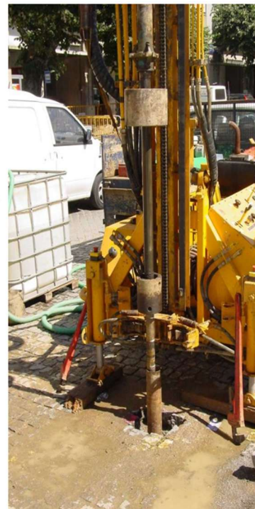
Figura 8 – Características do equipamento do ensaio SPT (Retirado de: Arquivo Mota-Engil).
