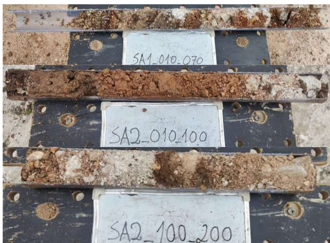
Figura 59 - Exemplo de sondagens recolhidas em campo (arquivo: Mota Engil). Neste caso, podem ser observadas as sondagens SA1_010_070 (Recolhida entre os 10 e os 70 cm de profundidade); SA2_010_100 (Recolhida entre os 10 e os 100 cm de profundidade); SA2_100_200 (Recolhida entre os 100 e os 200 cm de profundidade).
